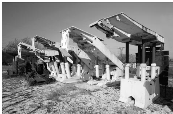
2. kép: Hidraulikus fejtésbiztosító berendezések
