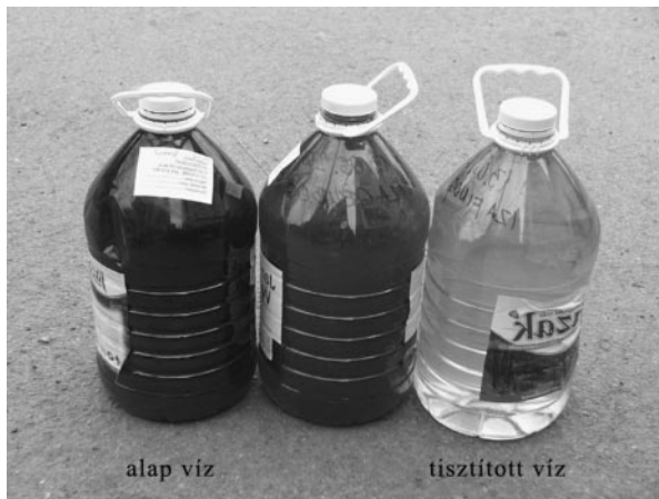
3. ábra: Kiinduló olaj tartalom 10 mg/l, lebegő anyag 2 mg/l. Megtisztítva: olaj 0,13 mg/l, szilárd 0,01 mg/l
