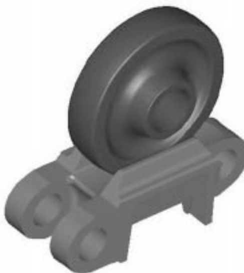
2. ábra: Görgő-láncalptörzs 3D-s alapmodell
