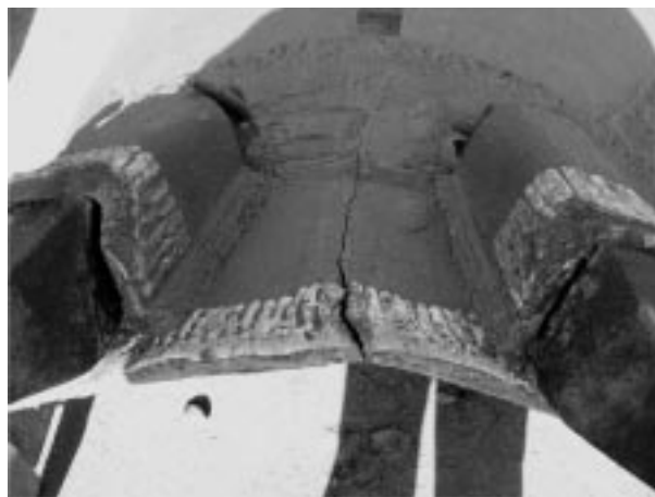
2. ábra: Szilárdsági problémát sejtető vágóél berepedés
