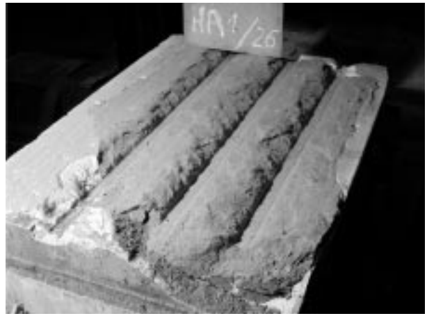
3. ábra: Homokosagyag minta, forgácsolás után
