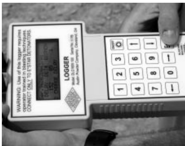
4. ábra: DLG1600-100 logger
