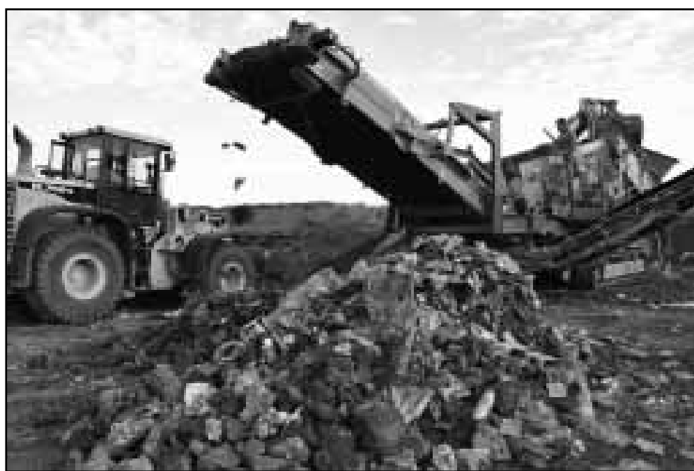
A szelektáló gép három részre különíti el a sarkadiak évtizedek alatt „felhalmozott” hulladékát
