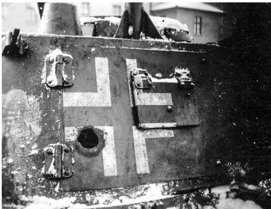
6. kép. Lackó Győző főhadnagy kilőtt harckocsijának lövegtornya, amelyen jól látszik az ellenséges páncéltörő lövedék becsapódási nyoma. Jászberény, 1942 eleje 27
