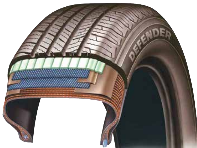
Az abroncs szerkezete, mintázata és anyaga határozza meg, mire alkalmas
