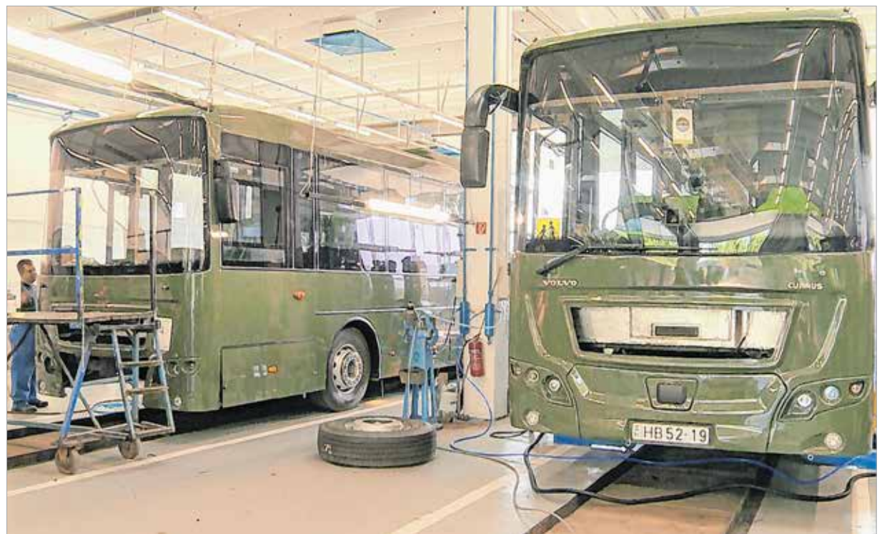
Ez már a végszerelés közbeni állapot. A Magyar Honvédség számára nyolcvan ilyen járművet gyártanak.
