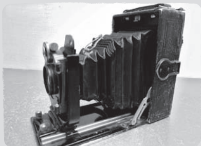
A camera obscura kései utóda, egy 19. századi faváz, harmonikás felépítésű fényképezőgép
