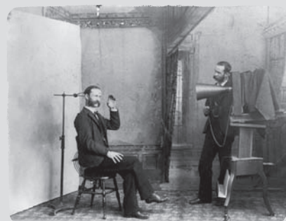
A hosszú exponálási idő még az 1890-es években is szükségessé tette a fejtámaszok használatát a fotóstúdiókban
