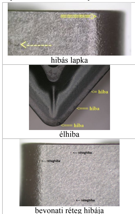
5. ábra Vizsgálatra alkalmatlan lapkák
