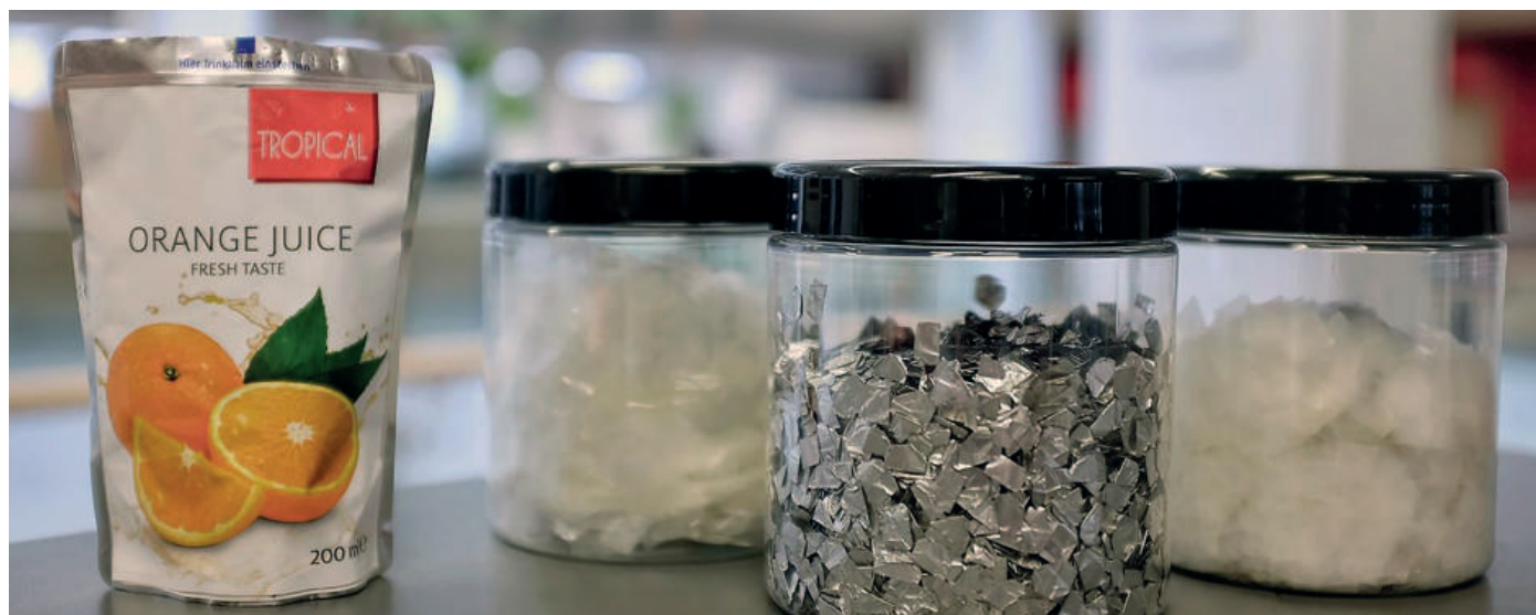
Társított anyag rétegeinek szétválasztása - Saperatec
