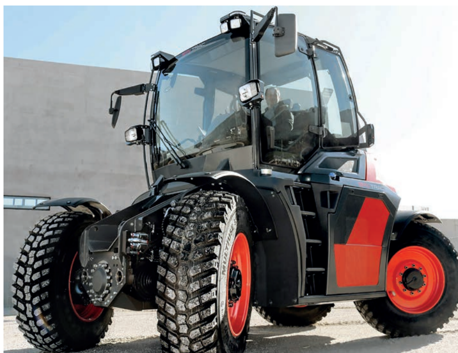
1. kép. Syn Trac többfunkciós erőgép 420 lóerős Caterpillar motorral, 4 x 4 kivitelben (forrás: grainews.ca)
