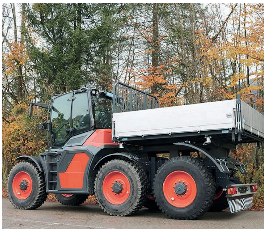
4. kép. Syn Trac erőgép 4 x 4 + 2 hajtásrendszerrel (forrás: grainews.ca)
