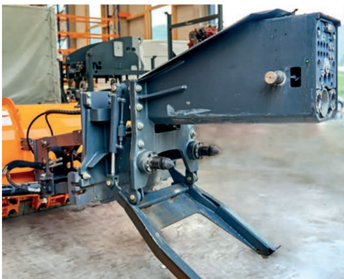
3. kép. Syn Trac erőgép- és munkaeszköz-kapcsolat szerkezeti elemei (forrás: syn-trac.at)
