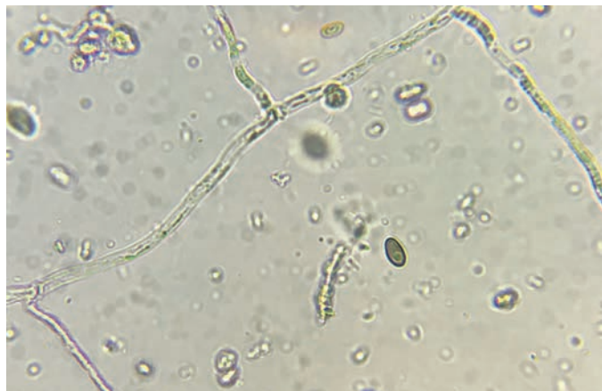
1. a, b kép. Mikroszkopikus gombák micéliuma a kerti komposztos kezelésben (bal) és kovamoszatok elhalt vázai a kovaföldes kezelésben (jobb) – 400-szoros nagyítás
