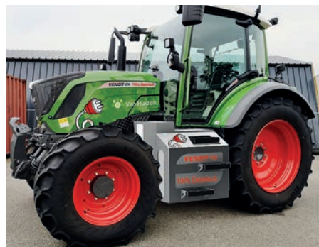
1. kép. Teljesen elektromos traktorrá átalakított Fendt 313 Vario traktor (forrás: www.fendt-e.nl)
