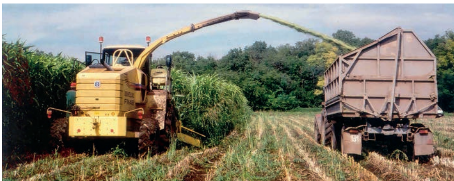
3. kép. Silókukorica betakarítása forgótárcsás adapterrel szerelt magajáró szecskázóval
