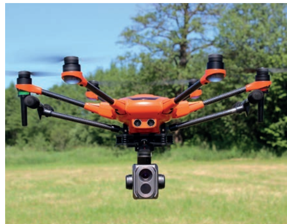
Yuneec E20Txv duál kamera Yuneec H520e ipari drónra szerelve
