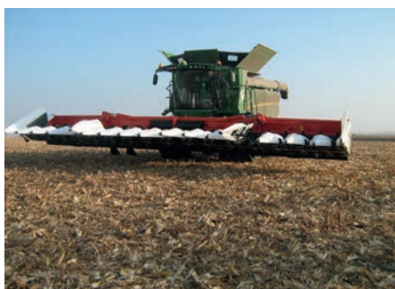
5. kép. 16 soros csőtörővel felszerelt nagy teljesítményű axiáldobos gép
