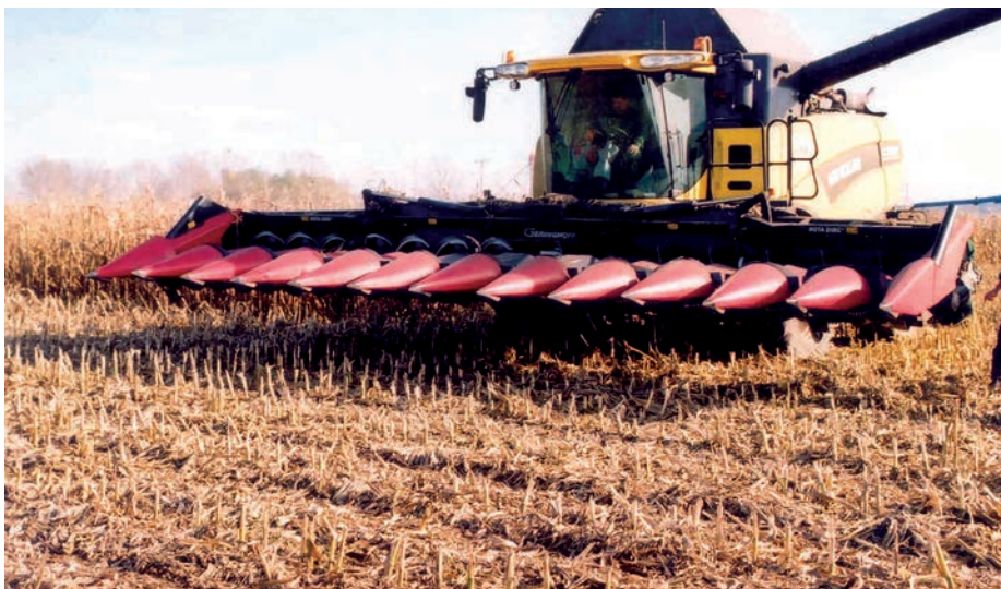
4. kép. Kombinált cséplőszerkezetű gép 12 soros adapterrel
