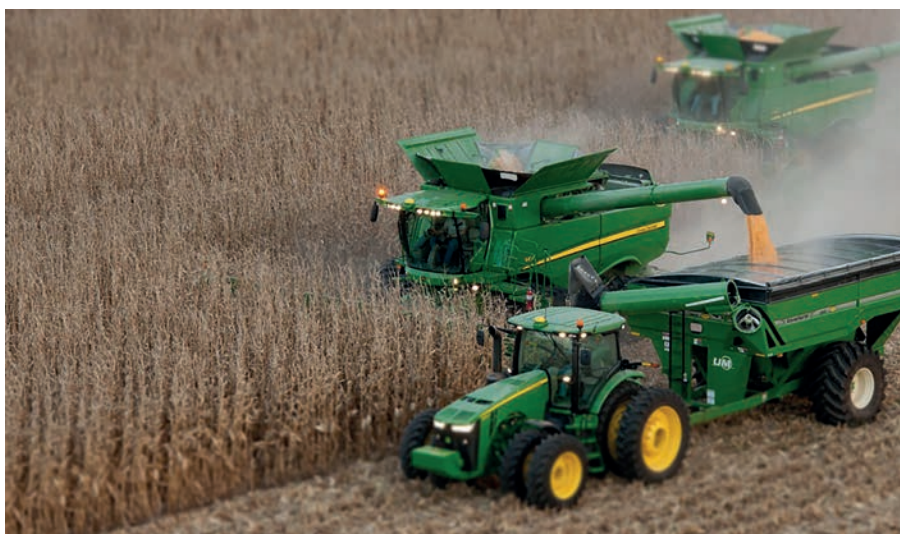
7. kép. A gyűjtő-átrakó kocsik és a GPS-alkalmazások jelentősen növelhetik a kukoricabetakarítás hatékonyságát
