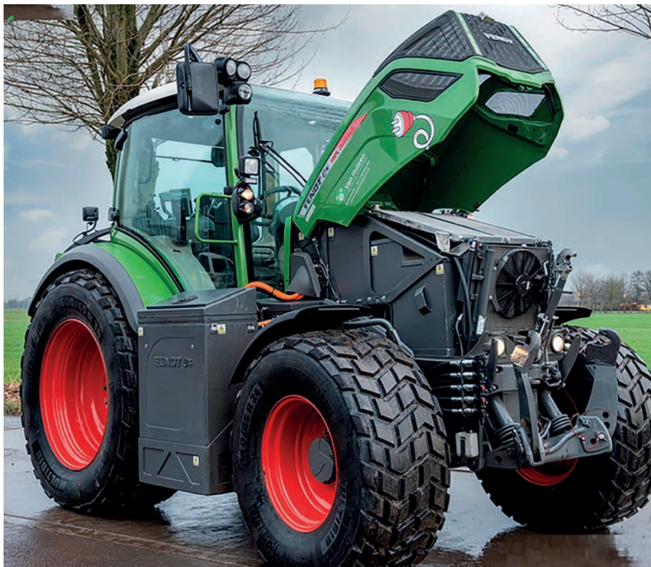
3. kép. Az átalakított „Fendt-e” jelzésű, teljesen elektromos traktor (forrás: https://www.fendt-e.nl/technik/ )
