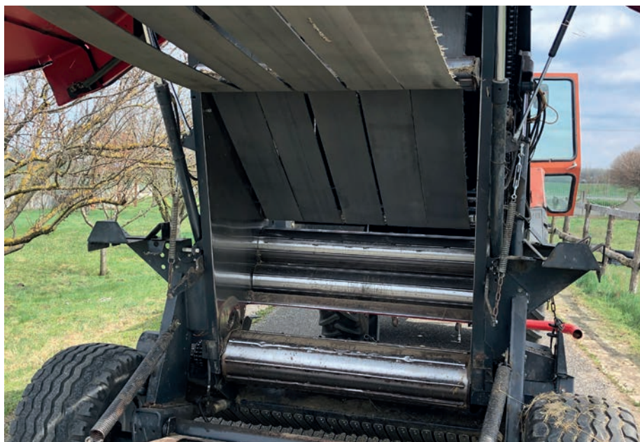
Ellenőrizzük a hevederek futásának távolságát, mert ezek összesűrűsödése is okozhat tüzet
