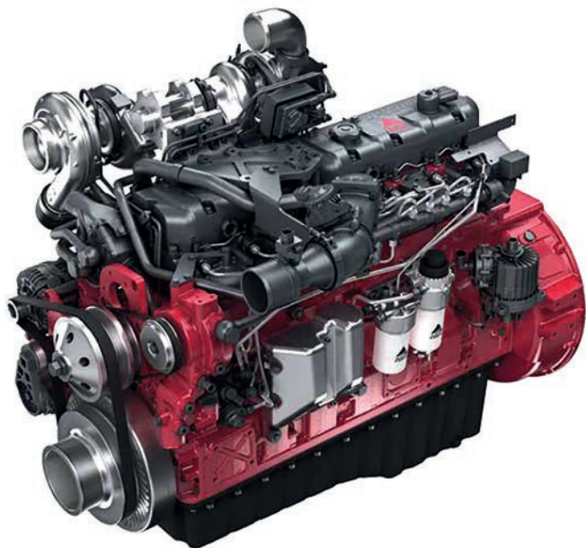
4. kép. AGCO Power 98 L HD típusú, 7 hengeres, 9,8 literes, 461 lóerős dízelmotor (forrás: www.agcopower.com)
