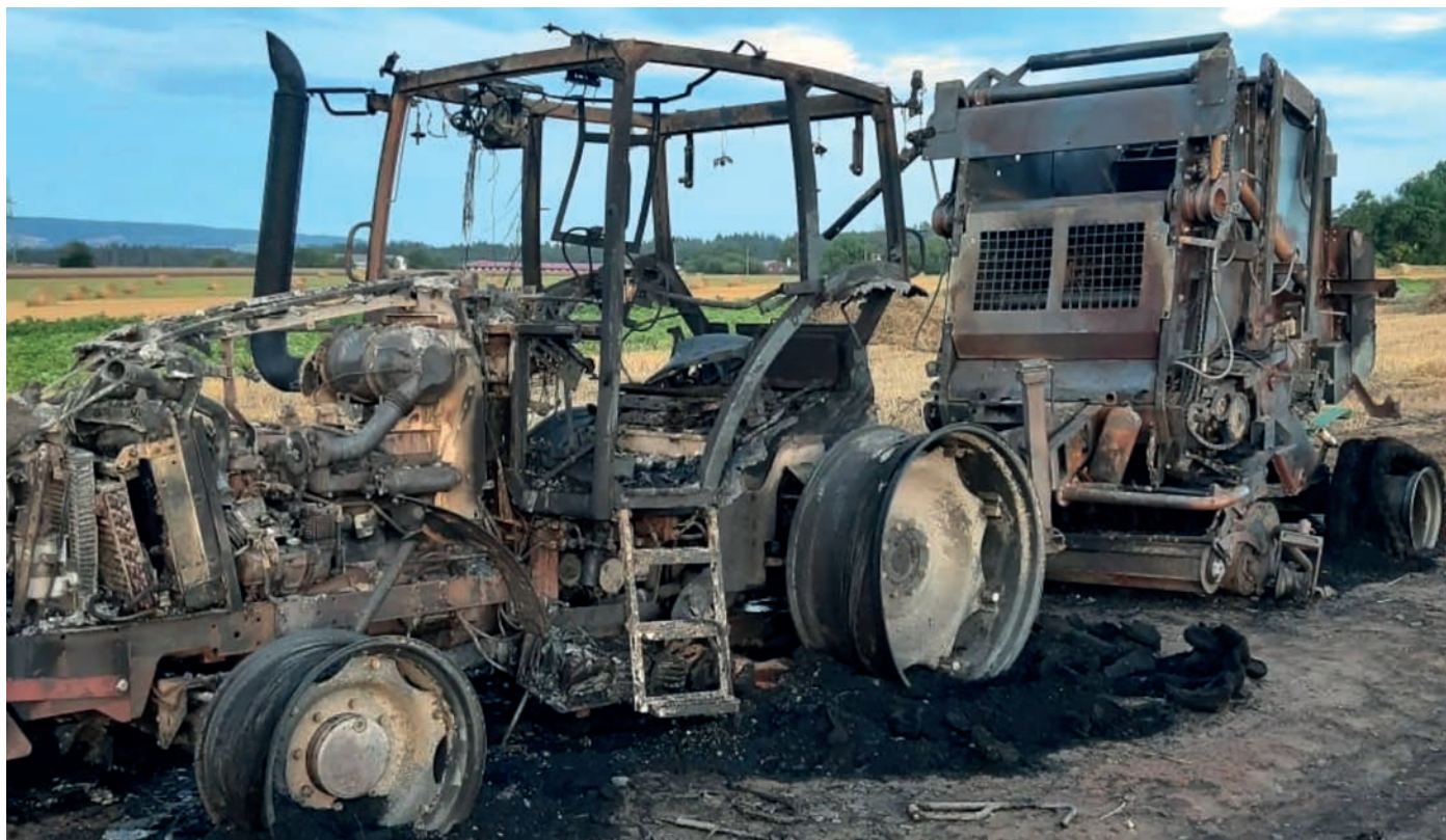
Mérleljünk, és ha kell, akkor először a gépet kapcsoljuk le, és csak utána küzdünk a lángokkal, mert ellenkező esetben így is járhatunk
