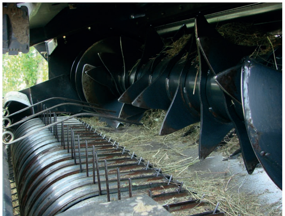
A rendfelszedőnél a behordócsiga és rotor bemelegedett csapágyazása okozhat tüzet
