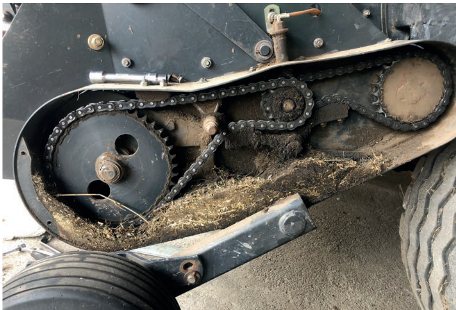
A láncok csapágyazása is okozhat tüzet, ha elhasználódik és túlmelegszik
