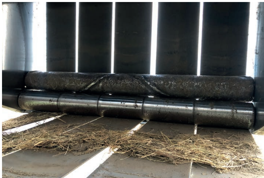
A hevederfeszítő görgők csapágyazásának a meghibásodása a bálázótüzek egyik leggyakoribb oka
