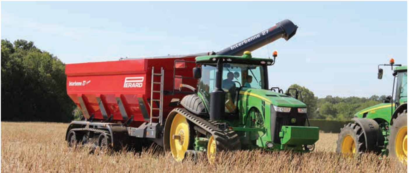
Gumihevederes járószerkezetű erőgép + átrakó kocsi. Teljesen talajkímélő gépcsoport betakarítógépek kiszolgálásához (fotó: https://www.perard.fr/ )
