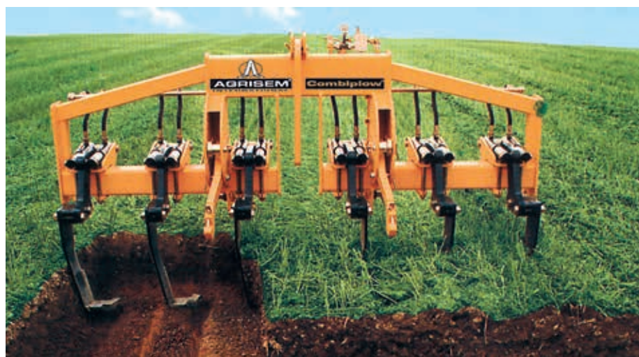
5. kép. A ferdekéses lazítók munkaeszközei felemelik a gypnemezt
