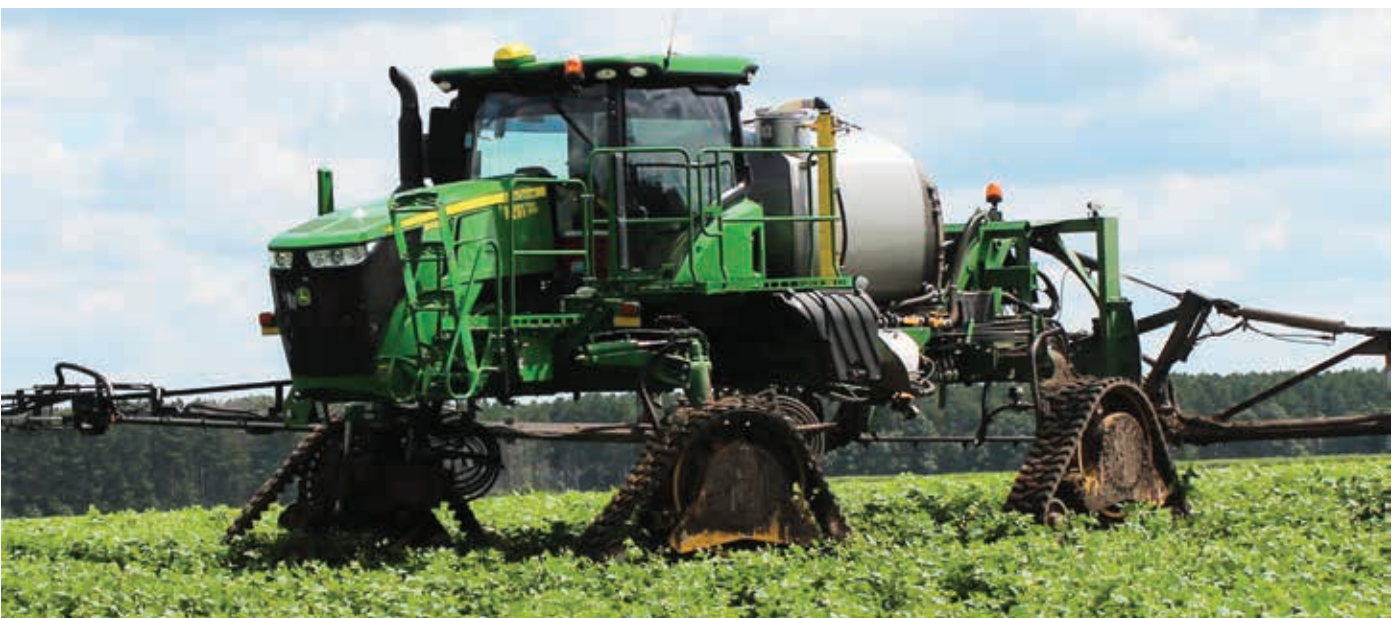
A legnagyobb darabszámban alkalmazott önjáró permetezőkhez is elérhetők Triangle hevederes rendszerek (fotó: https://matracks.co/ )
