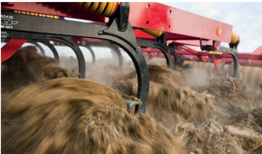
10-12 km/h munkasebességet el kell érni, akkor dolgoznak jól a kapák
