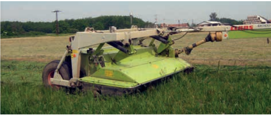
1. kép. Telepített gyepék tisztítókaszálása vontatott, tárcsás kaszával
