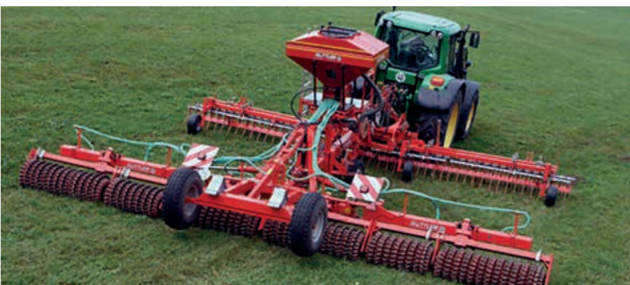
8. kép. Tavaszi gyeppápoló, felületvető gépkombináció munka közben
