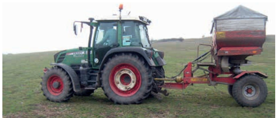
6. kép. Gyepek tápanyag-visszapótlására is hatékonyan használhatók a röpitőtárcsás műtrágyaszórók
