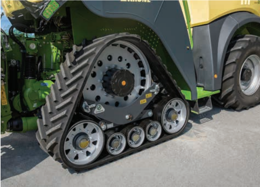
Szimmetrikus Triangle gumihevederes rendszer önjáró silózó tengelyén (fotó: krone.de)
