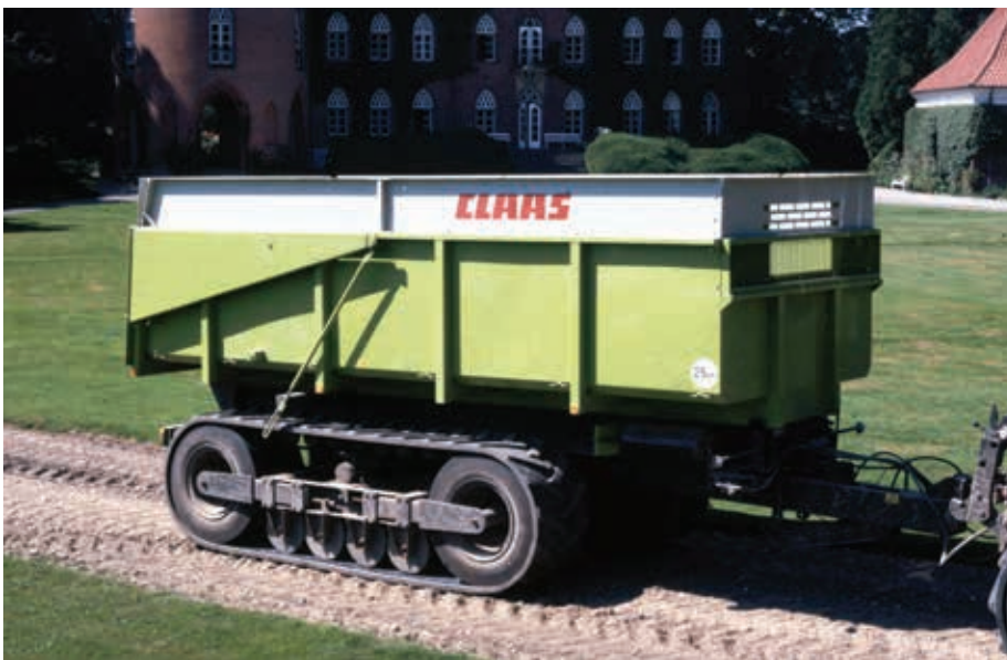
A 80-as évek végén alkalmaztak mezőgazdasági pótkocsi futóműként gumihevederes rendszert (fotó: https://mediatum.ub.tum.de/ )
