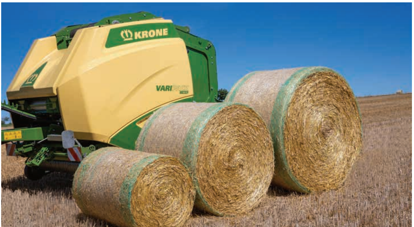
A VariPack V 165 bálázó esetében a bálaátmérő fokozatmentesen állítható 80 cm-től 1,65 m-ig
