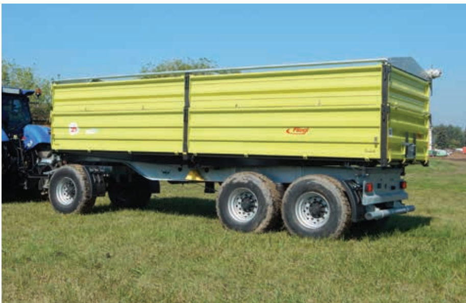
2. kép. Háromtengelyes, mezőgazdasági körülményekre fejlesztett, légrugós hátsótengely-felfüggesztésű, forgószámolyos pótkocsi
