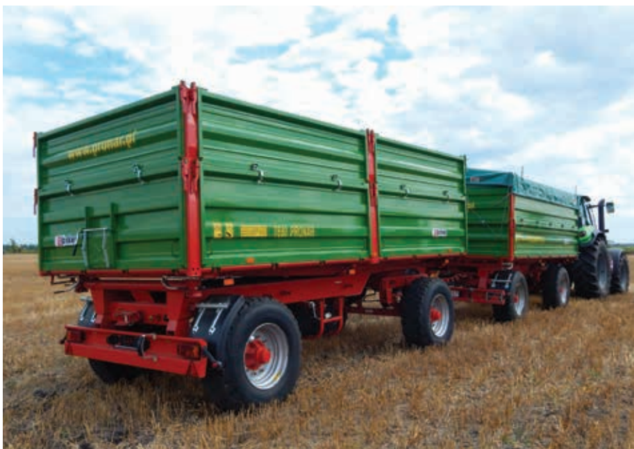
1. kép. A forgószámolyos, kéttengelyes konstrukciók előnye, hogy járműszerelvénybe összekapcsolva is alkalmazhatók
