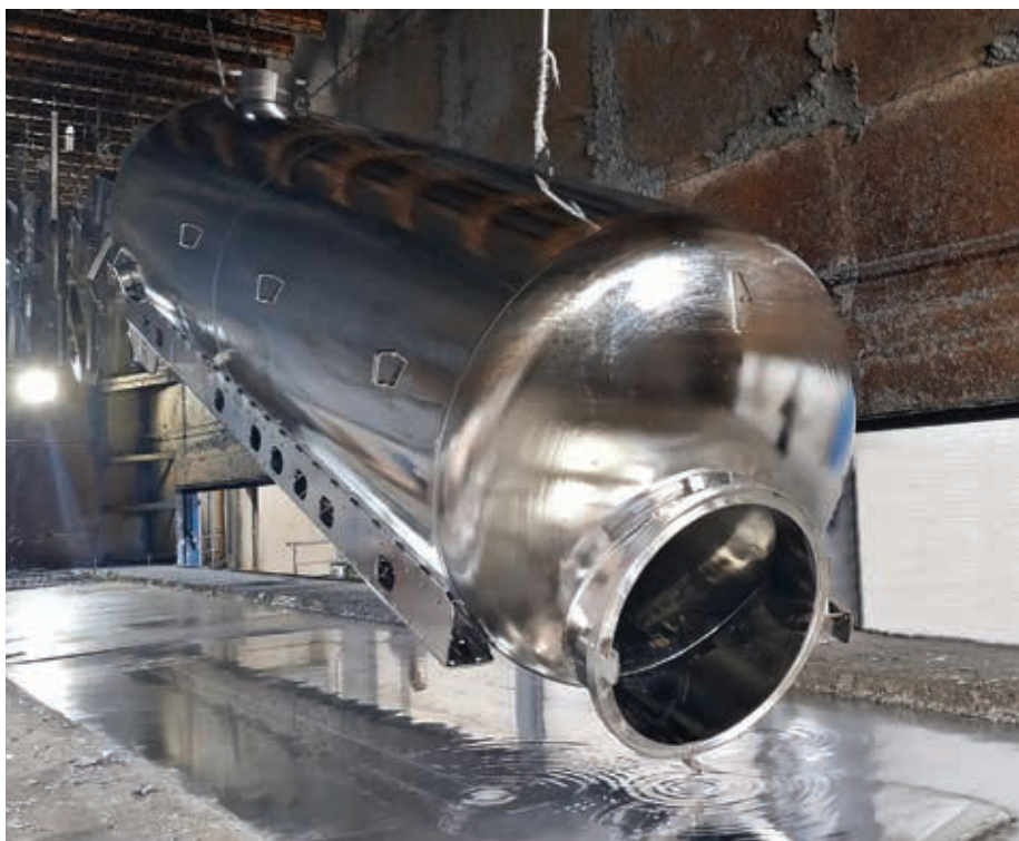
Mezőgazdasági acéltartály tűzhorganyzása a NAGÉV CINK Kft. ócsai üzemében
