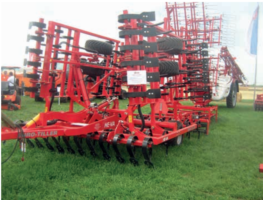
4. kép. Vésőalakú, keskeny munkaeszközzel szerelt, összecsukható vázkeretű szántóföldi kultivátor
