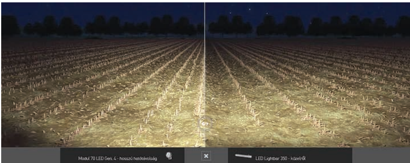
2. kép. Balra „Modul 70 LED Gen IV”, jobbra „LED Lightbar 350” fényszórók világításának összehasonlítása ELIVER program segítségével (forrás: www.hella.com/eliver)
