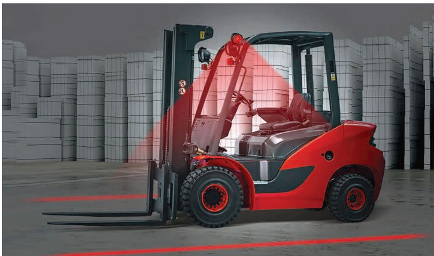
4. kép. Hella „SL60 LED” figyelmeztető munkalámpa sávalakú fénye (forrás: www.hella.com/press )
