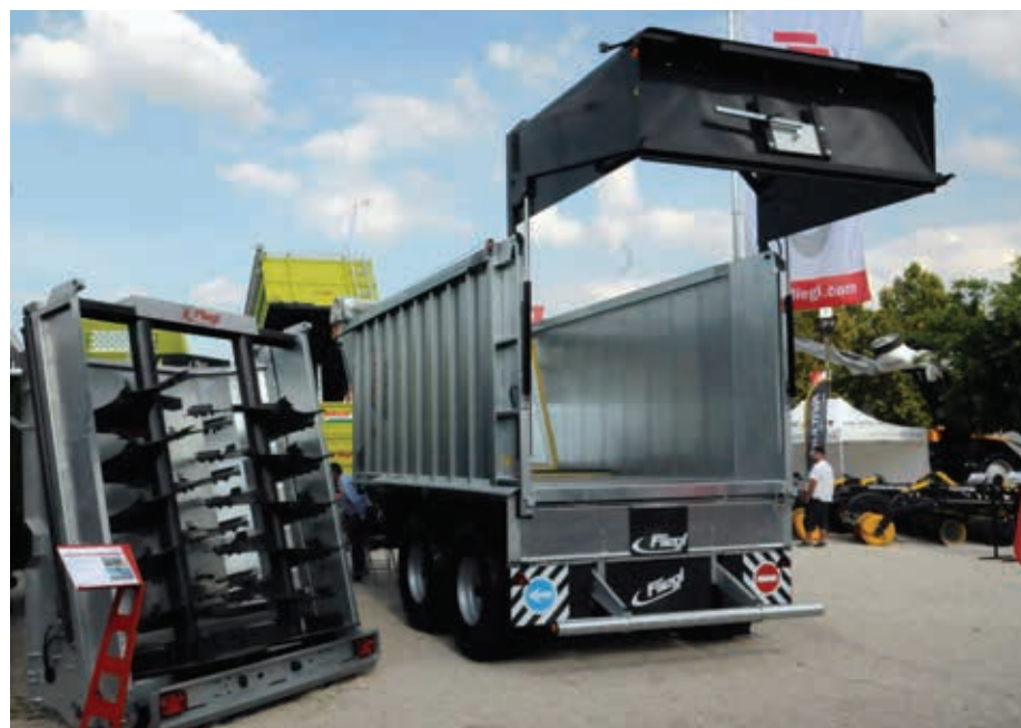
6. kép. A letoló rendszerű pótkocsik egyik nagy előnye a hátfaladapterek cserélhetősége
