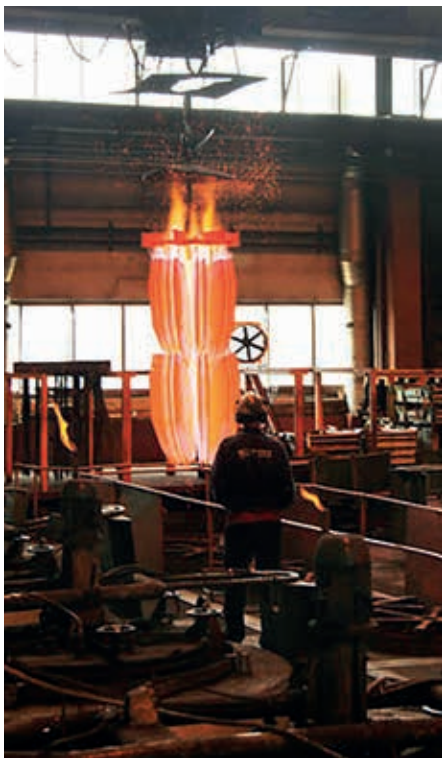
3. kép. Az újabb CAM számítógépes módszerrel irányított gyártástechnológiában a kopó alkatrészeket gyakran hőkezelik
