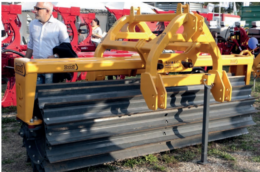
2. kép. Melső és hátsó hárompontfüggesztésre egyaránt csatlakoztatható, nagy átmérőjű száraprító henger
