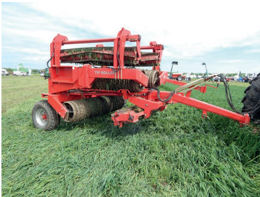
5. kép. „V” késelrendezésű aprítóhengerrel szerelt Cambridge henger
