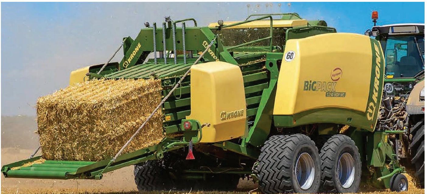
1. kép. S2b járműkategóriájú Krone BiGPack 1290 HDP VC vontatott bálázógép tandem légfékes futóművel, forrás: www.krone.de
