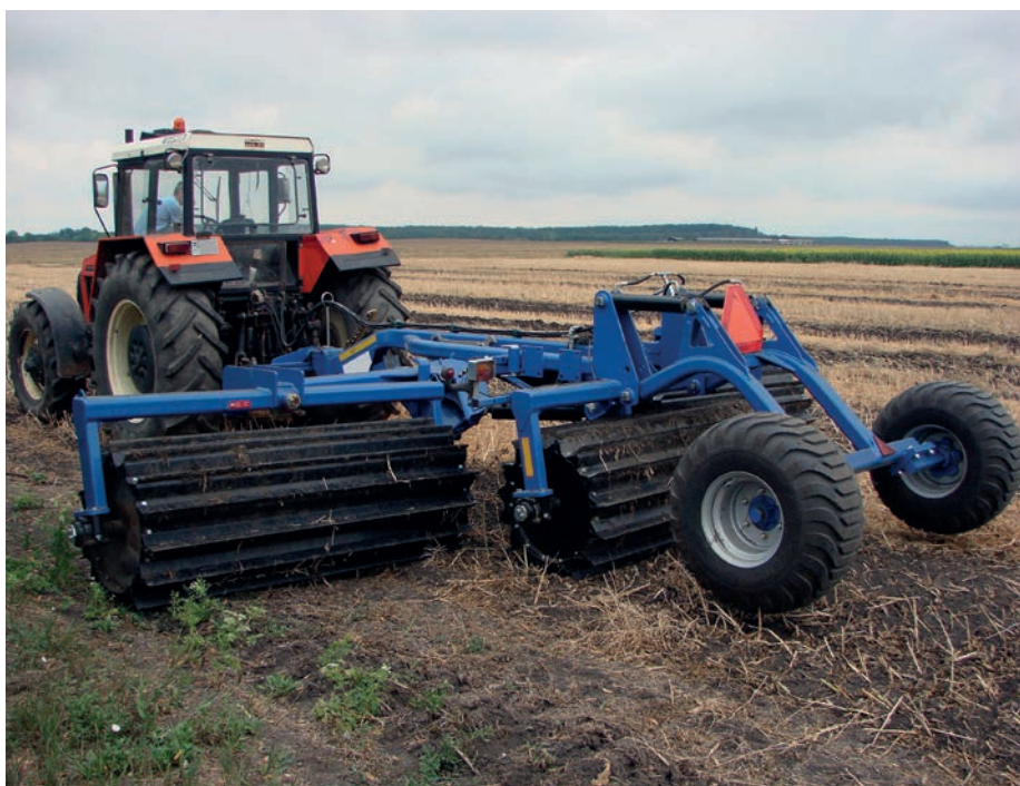
1. kép. Vontatott háromtagú, nagy átmérőjű kések száraprító henger
