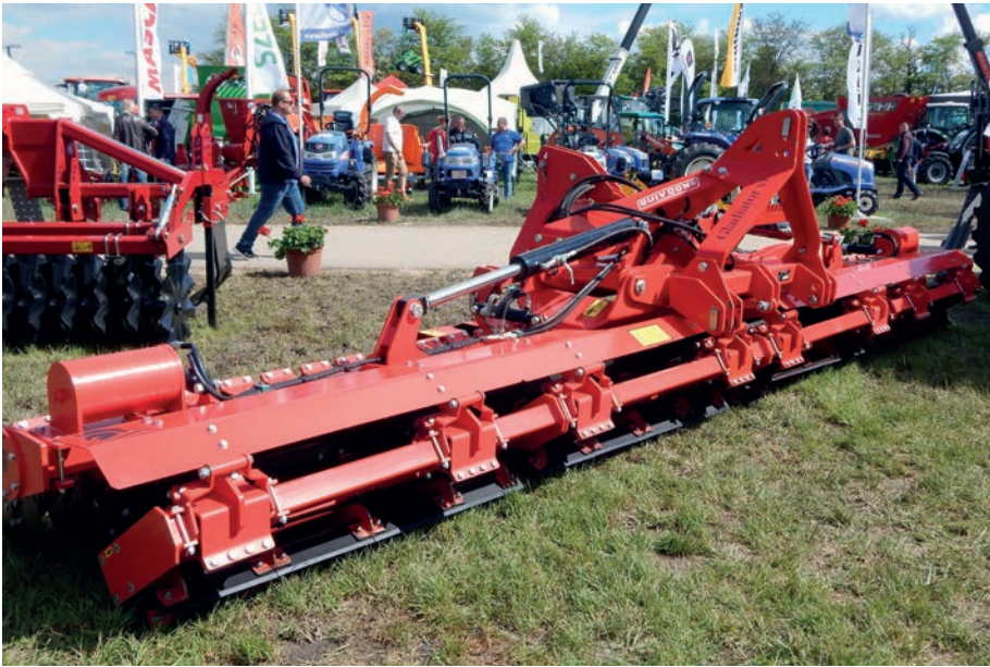
3. kép. Front- és hátsó hárompontfüggesztésre csatlakoztatható, kisebb átmérőjű keshengerrel szerelt modell, síktárcsasorral kombinálva
