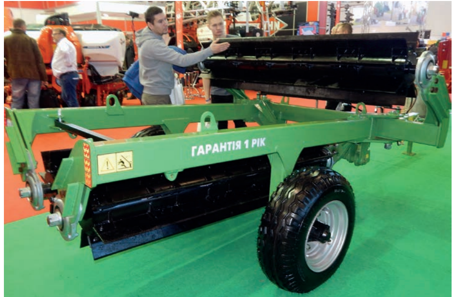
6. kép. Rögtörő tömörítőhenger-vázba épített, vontatott késes száraprító henger
