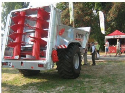
3. kép. A szervestrágya-szórók kocsiszekrényét korrózióknak ellenálló anyagból készítik, vagy a korrózióknak ellenálló felületvédelemmel látják el
