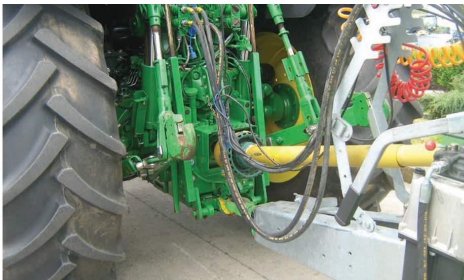
7. kép. A szórószerkezet hajtása mindig a TLT-ről történik, állandó fordulatszámmal
