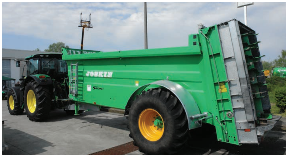
1. kép. Nagyméretű, alacsonynyomású gumibroncsozású, erős, robusztus futóművel szerelt szervestrágya-szóró pótkocsi
