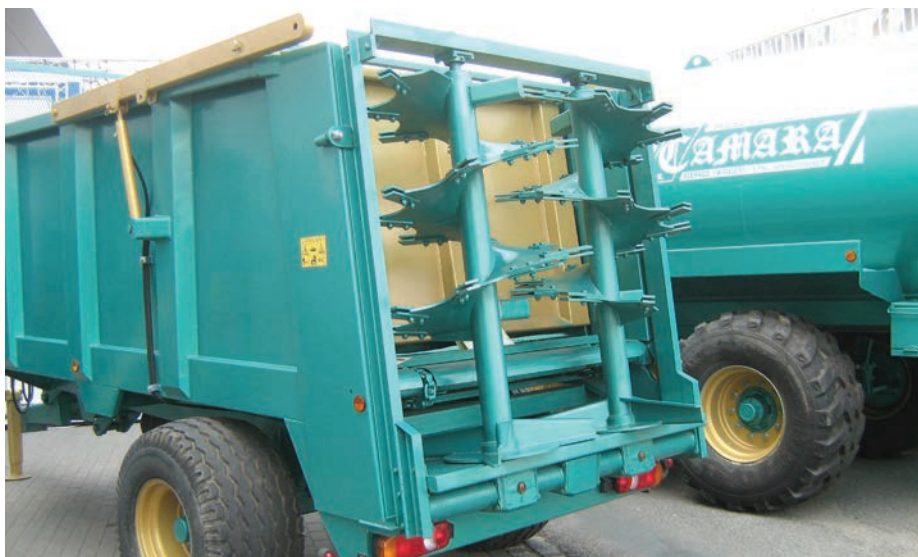
8. kép. Láncos, kaparóléces lehordó és kopásálló fém cserélhető tépőfogas szórószerkezet
