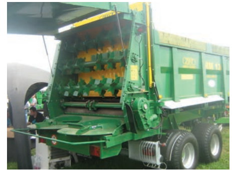
5. kép. Vízszintes tengelyű bontóhengeres szóróberendezés
