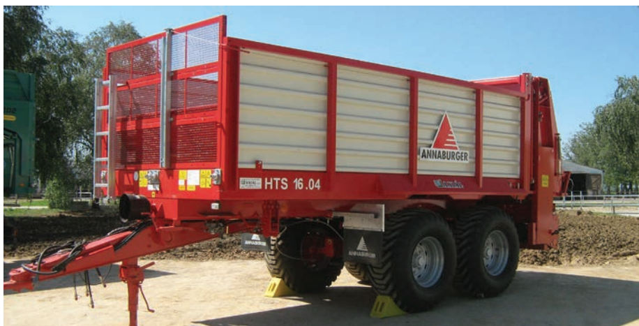
2. kép. A tandem futómű jelentősen csökkenti a szervestrágya-szóró pótkocsi mechanikai igénybevételét
