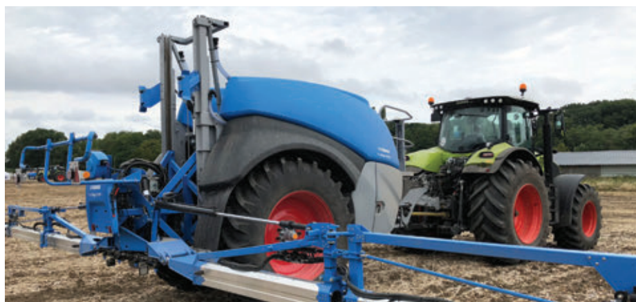
A Vega permetezőgép 3000, 4000 vagy 5000 literes tartállyal és 15-24 méteres SEH szórókerettel rendelhető
