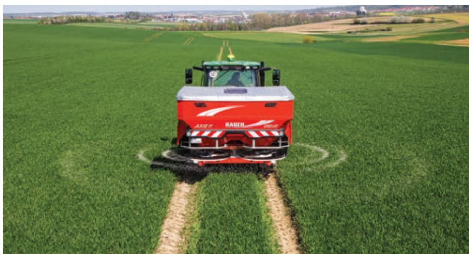
A jelenleg legkorszerűbb megoldást a szórótányérokat egyedileg – kifinomult szenzortechnikával és bonyolult szoftverekkel támogatott rendszerrel – figyelő EMC jelenti
