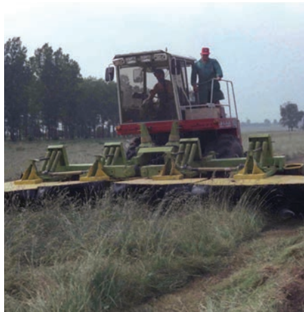
3. kép. A nagy hozamú gyepek, fűfélék vagy gabonák kaszálásában előnyt jelent a nagy anyagátesztő képességű dobos kaszák használata
