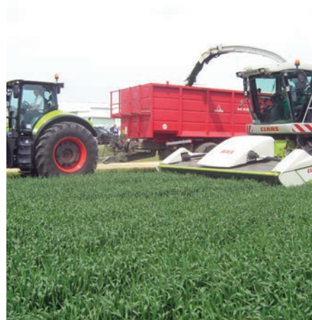
4. kép. Szántóföldi vágóasztallal felszerelt szecs-kászóval történő silózás
