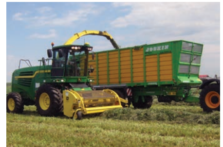
10. kép. Magajáró és ekázó és lefordószerkezettel rendfelszedő pótkocsi munka közben
