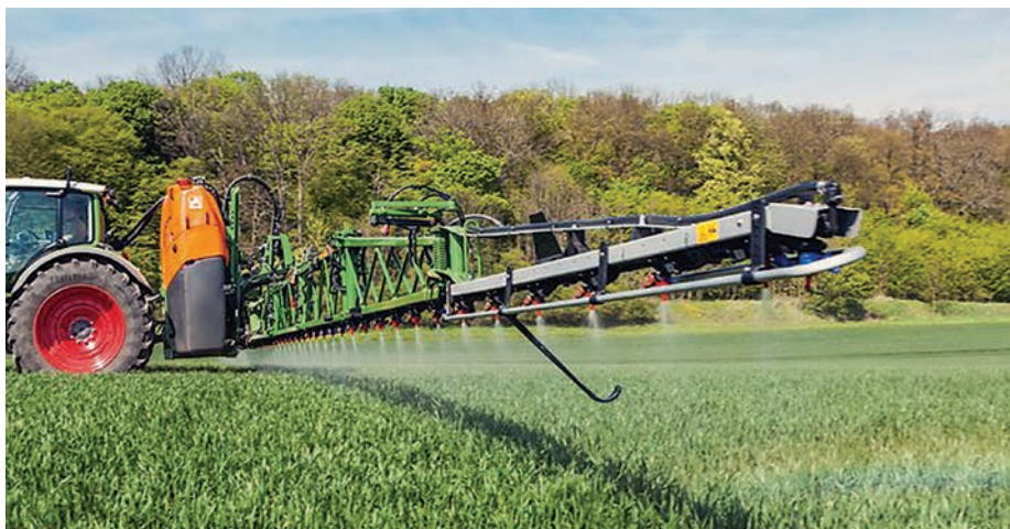
2. kép. Nagyobb területek kezelésére alkalmas függesztett szántóföldi permetezőgép (forrás: https://amazone.hu )
