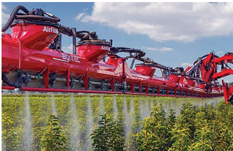
6. kép. Légrásegítéssel vontatott szántóföldi permetezőgép munka közben (forrás: https://www.agrifac.com/hu/optional-spray-technology/airflowplus )
