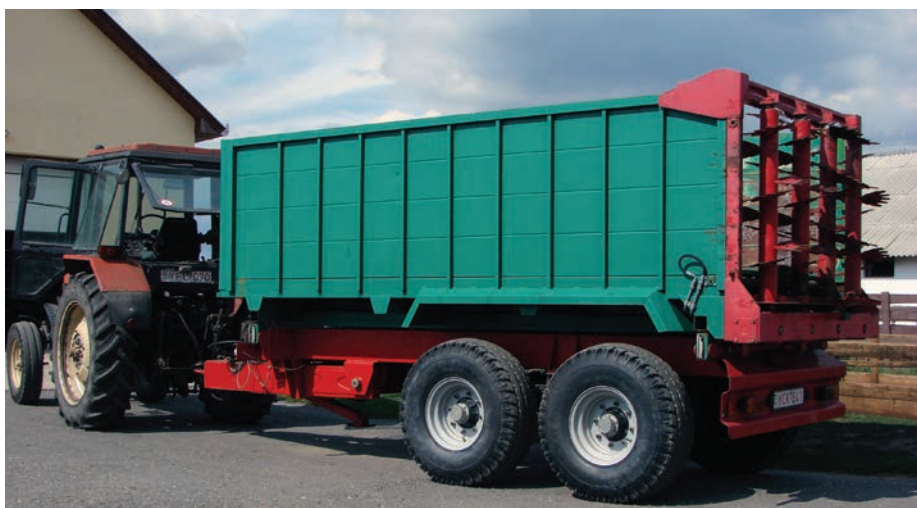
Az EB-10 CS hazai gyártású cserefelépítményes pótkocsi
