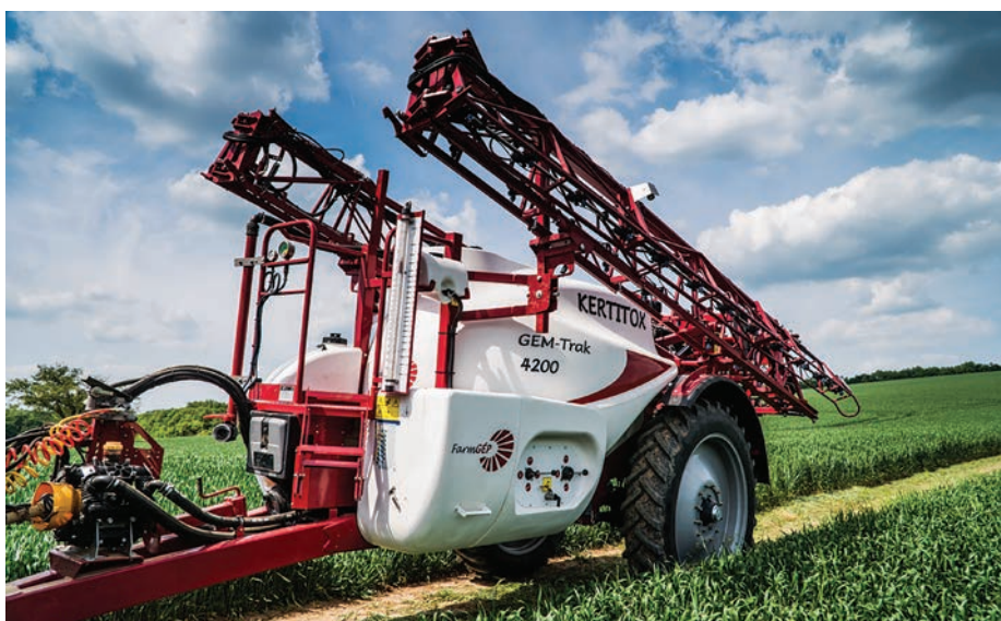
3. kép. Nagyobb területek kezelésére alkalmas vontatott szántóföldi permetezőgép (forrás: https://www.farmgep.hu/kertitox-gemtrak )
