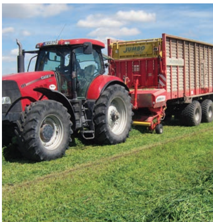
9. kép. Szeletelővel felszerelt rendfelszedő pótkocsi ősziárpa-szenázs betakarításban
