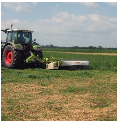
5. kép. Szilázs-, szenázs készítés technológiájában pillangós kalászos kaszálására ajánlható a gumihengeres tárcsás kasza
