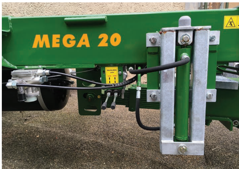
A ZDT Mega cserefelépítményes s éria univerzális alvázának egyik felépítménykiemelő munkahengere (fotó: https://www.zdt.cz/ )
