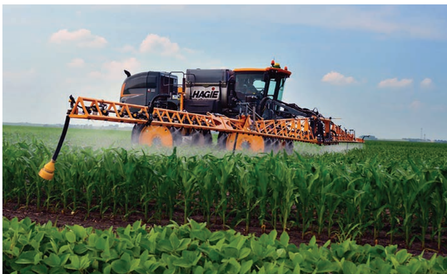
5. kép. Nagy teljesítményű önjáró szántóföldi permetezőgép (forrás: https://www.kite.hu/gepek-eszkozok/permetezok-mutragyaszorok/hagie-onjaro-permetezok/6/456 )
