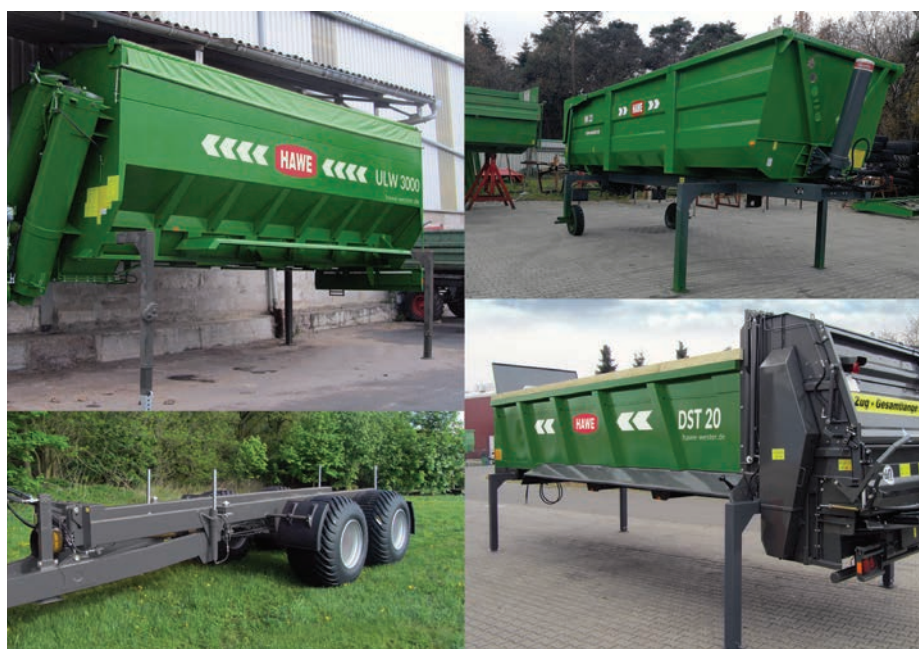
A Hawe WPS cserefelépítményes rendszer alváza és néhány felépítménye (fotó: https://www.hawe-wester.de )
