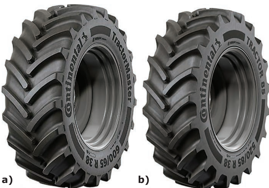
3. kép. Continental gumiabroncsok a John Deere 7R és 8R traktorszériához a) TractorMaster 600/65R38; b) Tractor85 520/85R38 (forrás: https://www.continental.com/en/press/... )
