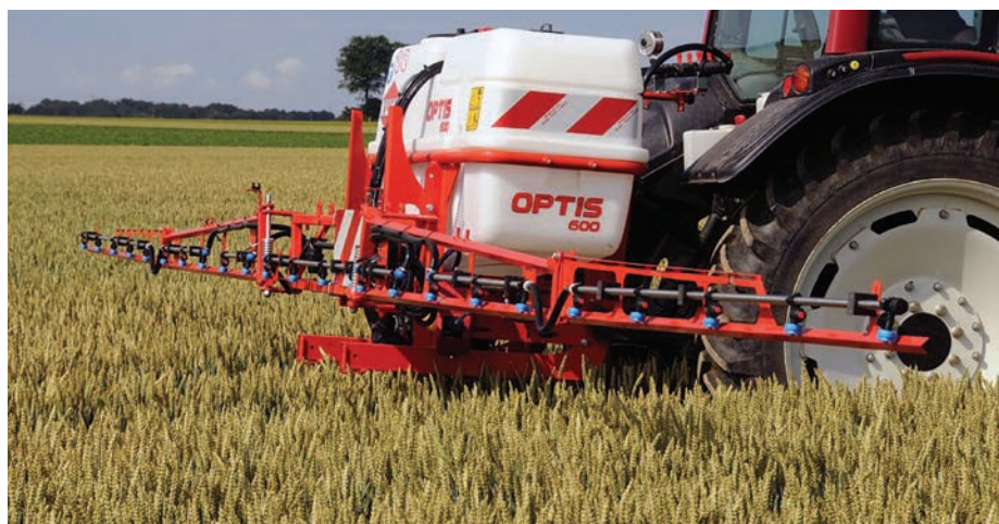
1. kép. Kisebb területeken alkalmazható függesztett szántóföldi permetezőgép (forrás: https://kuhn.co.hu/termek/optis-83303 )
