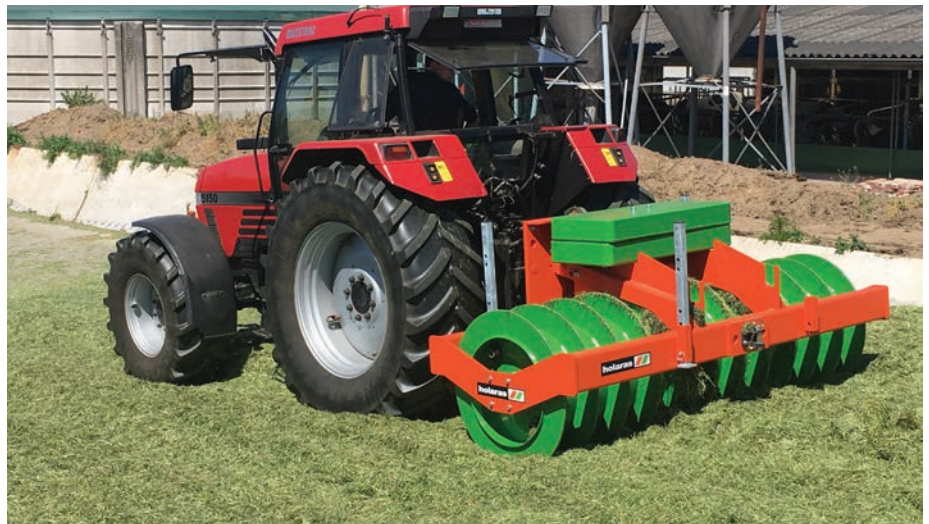
4. kép. Fűszilázs tömörítése pótsúlyozott silótömörítő hengerrel (fotó: holaras.nl)
