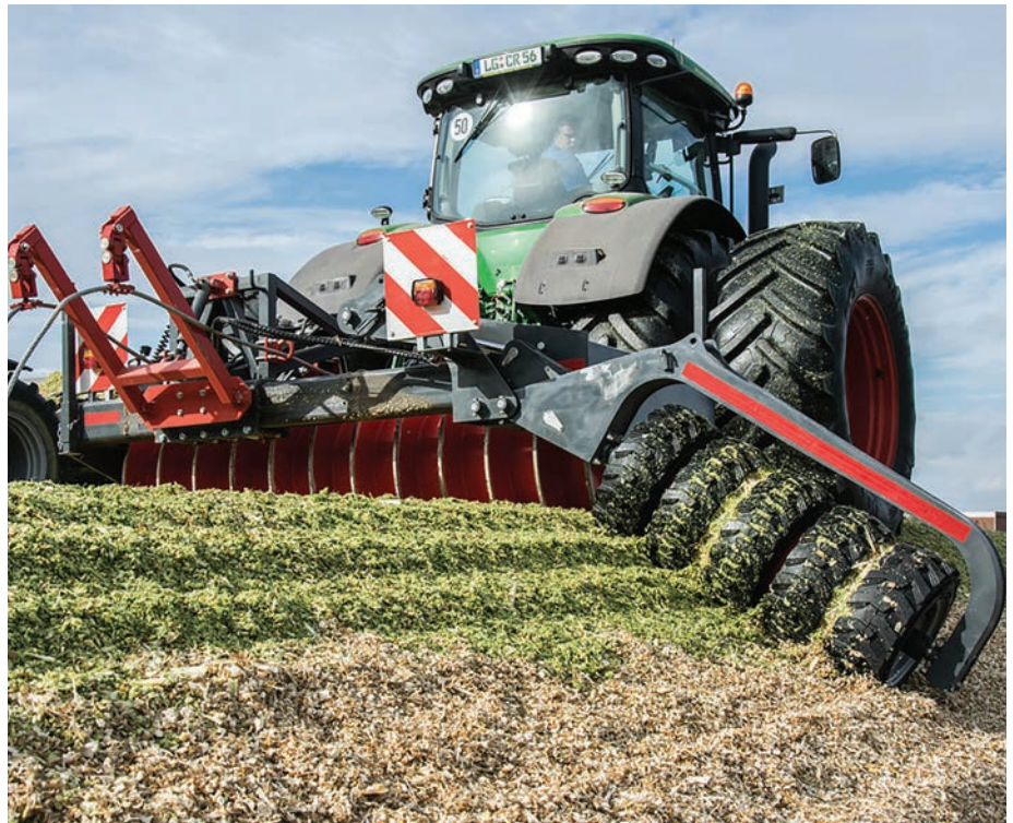
3. kép. Silóél-tömörítővel kiegészített tömörítőhenger (fotó: saphir-maschinenbau.de)
