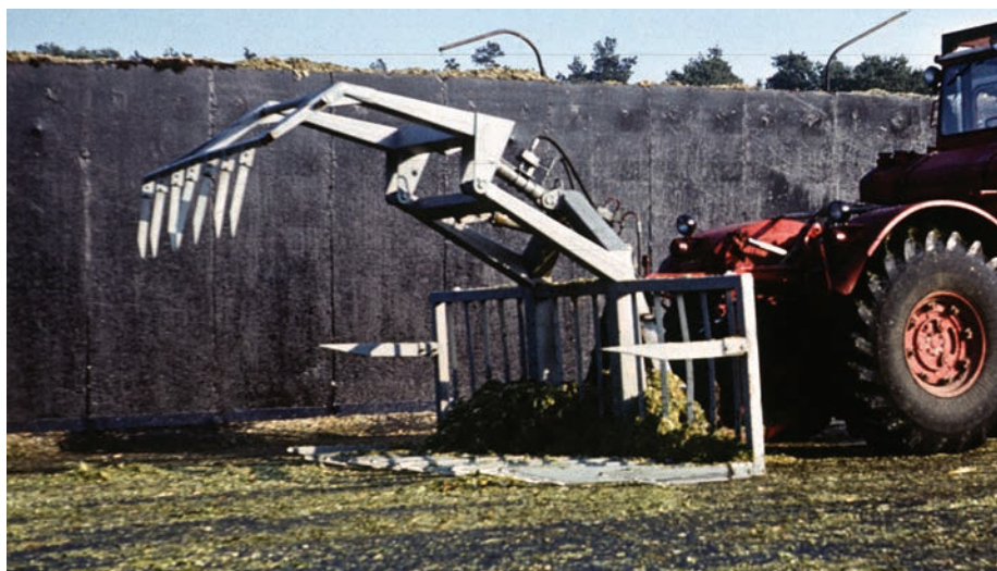
2. kép. Silótolóvilla törzscsuklós nagytraktoron (fotó: mediatum.ub.tum.de)
