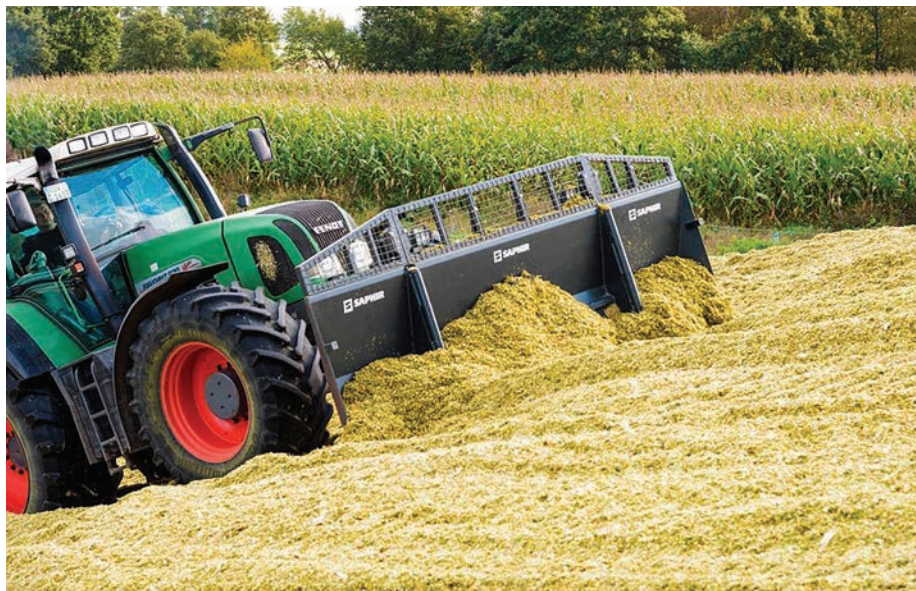
1. kép. Osztott laprendszerű, elfordítható silótolólap (fotó: saphir-maschinenbau.de)
