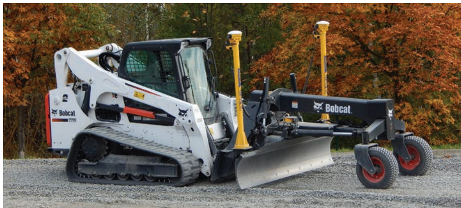
Már a csúszókormányzású, kompakt homlokrakodóhoz is elérhető gréder adapter
