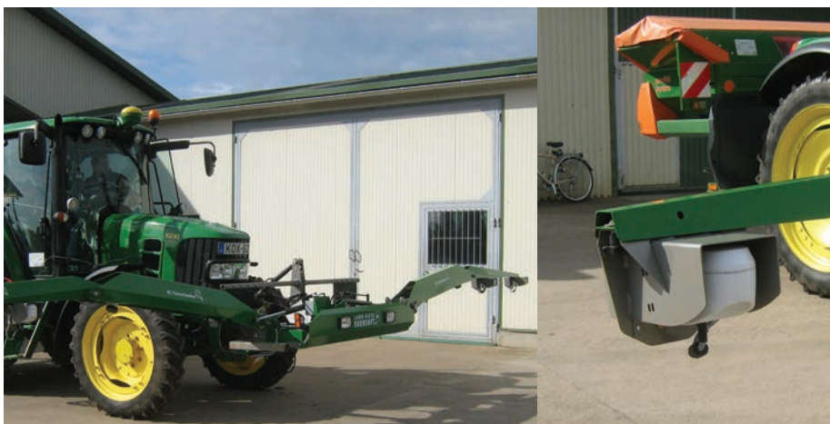
A Green-Seeker függesztő szerkezete és elhelyezett szenzorai
