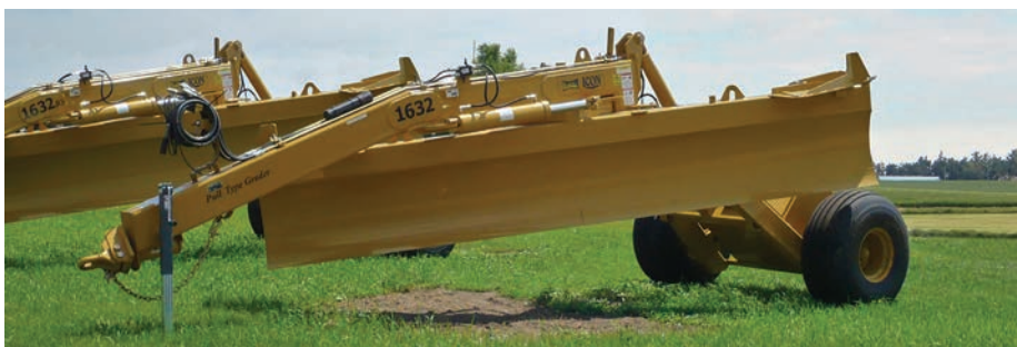
Négy méteres lapszélességű, vontatott gréder, hosszú gerendellyel
