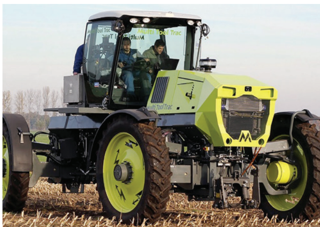
6. ábra A Multi Tool Trac típusjelzésű 160 kW-os soros hibridhajtású univerzális traktor (Forrás: www.multitooltrac.com/het-verhaal/ )
