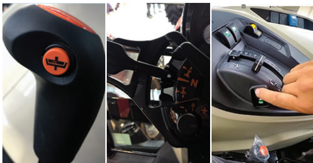
Hasznos opciók: kuplunggomb a váltókaron, elektro-hidraulikus irányváltó és EHR talajba kényszerítő funkcióval.
