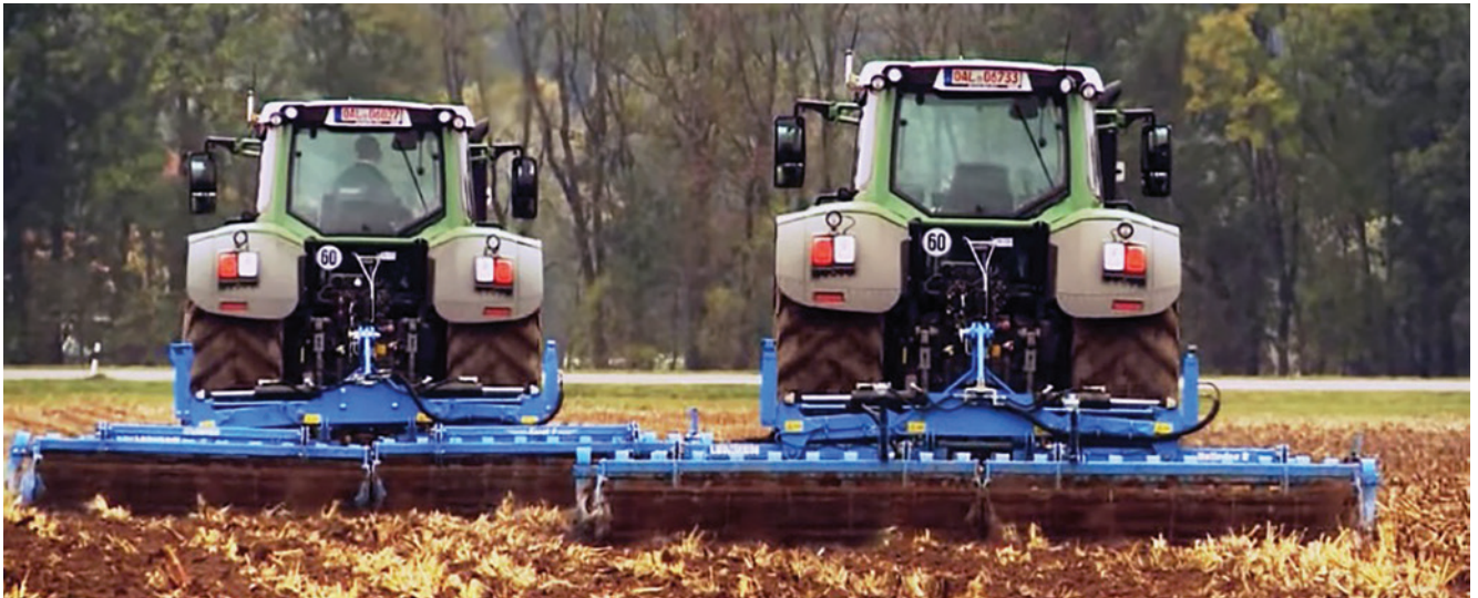
8. ábra A Fendt Guide Connect rendszerben két traktor egy gépkezelővel dolgozik (Forrás: www.fendt.com )
