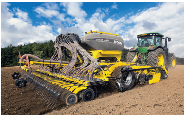
A paralelogramma felfüggesztésű vetőcsoroszlák garantálják a precíz maglehelyezést az egész munkaszélesség mentén.
