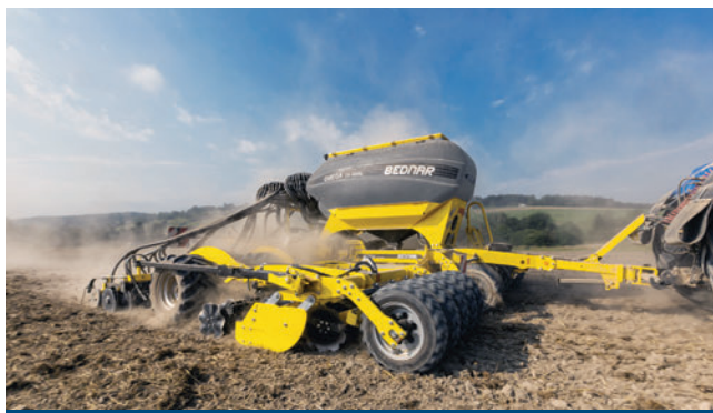
A 460 mm átmérőjű tárcsalapok a hullámos tárcsás egységgel kiegészítve tökéletes magágyat készítenek.
