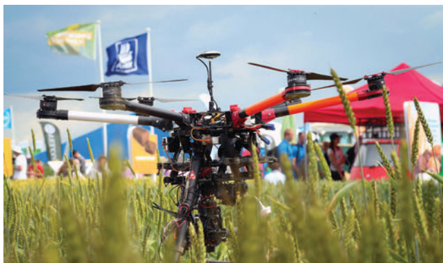
A SkyWRX DJI Inspire2 quadrokoptere Parrott Sequoia multispektrális érzékelőkkel állapítja meg az állomány jellemzőit
