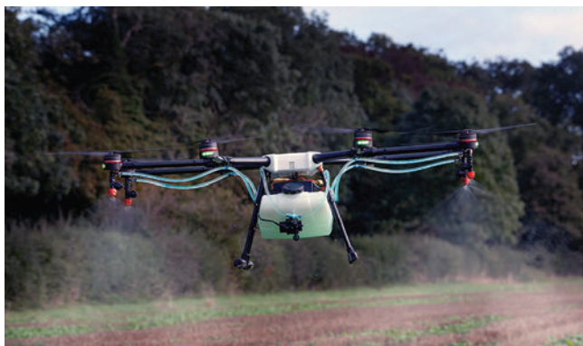
A CropAngel Agras MG-1 hígítatlan szerrel, jó porlasztással – amihez a drón propellerei is hozzájárulnak – több hektáryi terület lepermetezhető
