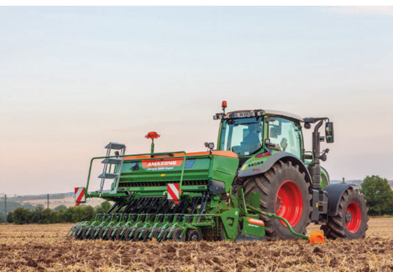
4.kép Amazone Cataya 3000 Super forgóboronás gabonavető gépkombináció
