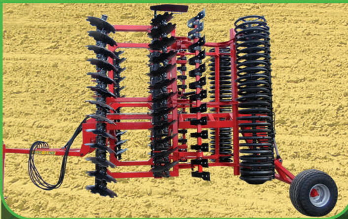
VT típusú rövidtárcsás borona 3,2 m-től 6 m-ig
