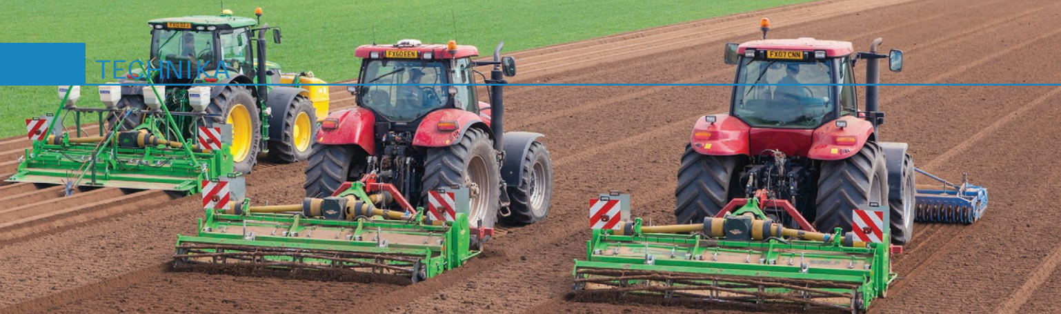
AVR gyártmányú rotációs talajmarók burgonya talaj-előkészítésében
