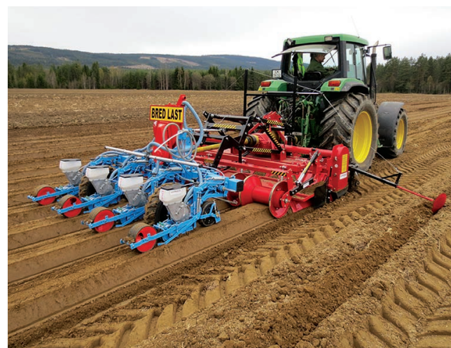
Talajmarós bakhátkészítés és vetés egy menetben (Massano RSE Plus+Monosem MS)
