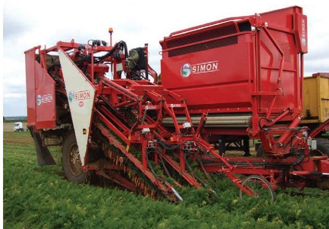
Simon R2B5 vontatott, két soros, gyűjtőtartályos betakarítógép
