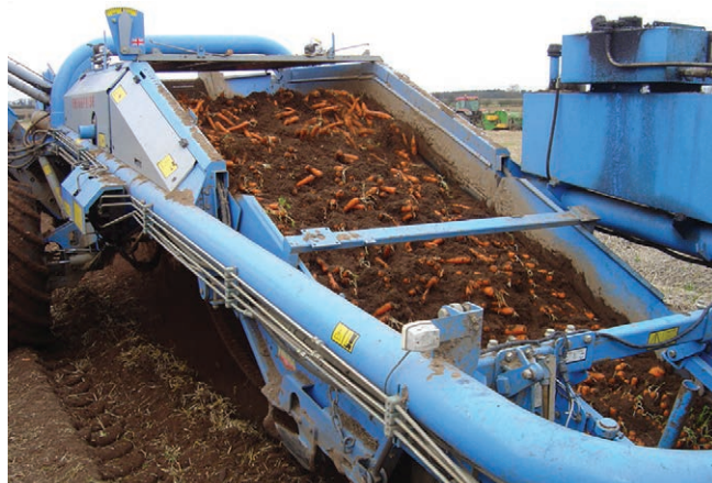
Sárgarépa-betakarítása ásórendszerű Standen Starstream kiásó-kocsirakó géppel
