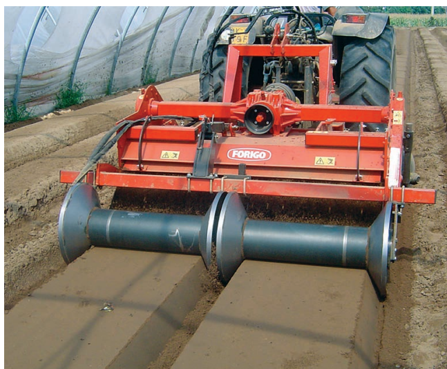
Keskeny ágyások készítése fóliasátorban (Forigo D45 Duplex)
