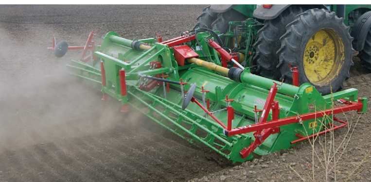
Nagy munkaszélességű Baselier HFD talajmaró csőpálcás lezáró hengerrel
