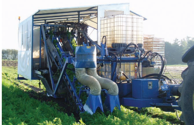
Sárgarépa lombozattal együtt történő csomózása és rekeszekbe gyűjtése Asa-Lift T 200 BU betakarítógéppel
