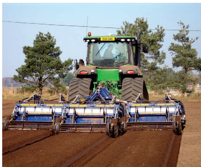
Nagy munkaszélességű George Moate 3 Bed Tillerstar ágyáskészítő (3x165 cm)
