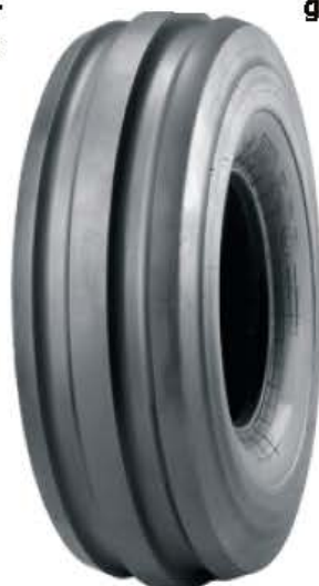
1. ábra: A kormányzó, nem hajtott gumibroncs mintázata
