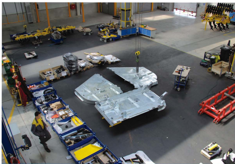
2. kép: A gépek összeszerelése egy speciálisan kialakított területen folyik. A váz körül a hozzárendelt alkatrészek találhatóak.
