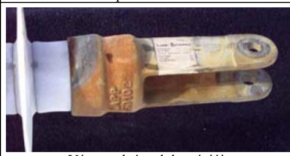
Vég szerelvények korróziója
