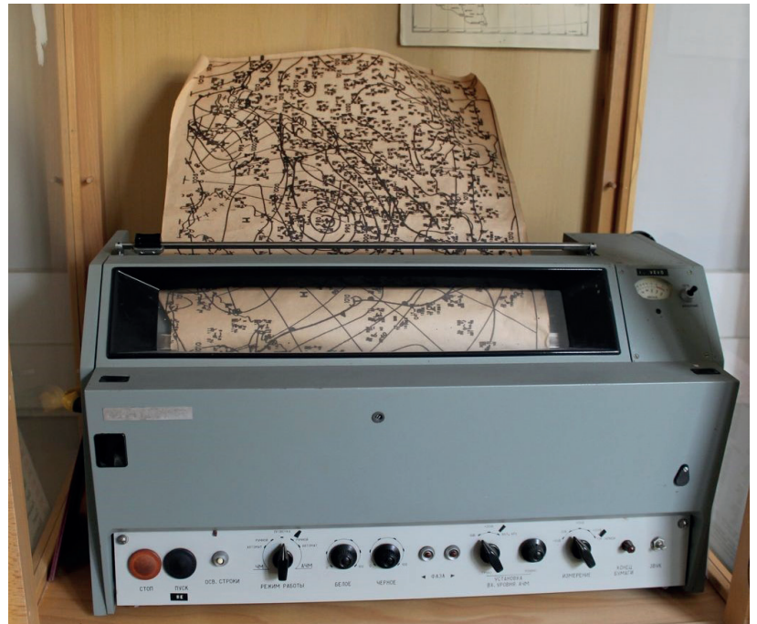
4. ábra: Ilyen LADOGA facsimile gépek vették a világhírközpontok előrejelzési térképeit (Meteorológiai Muzéalis Szakgyűjtemény, II. Kitaibel Pál utca 1.)
