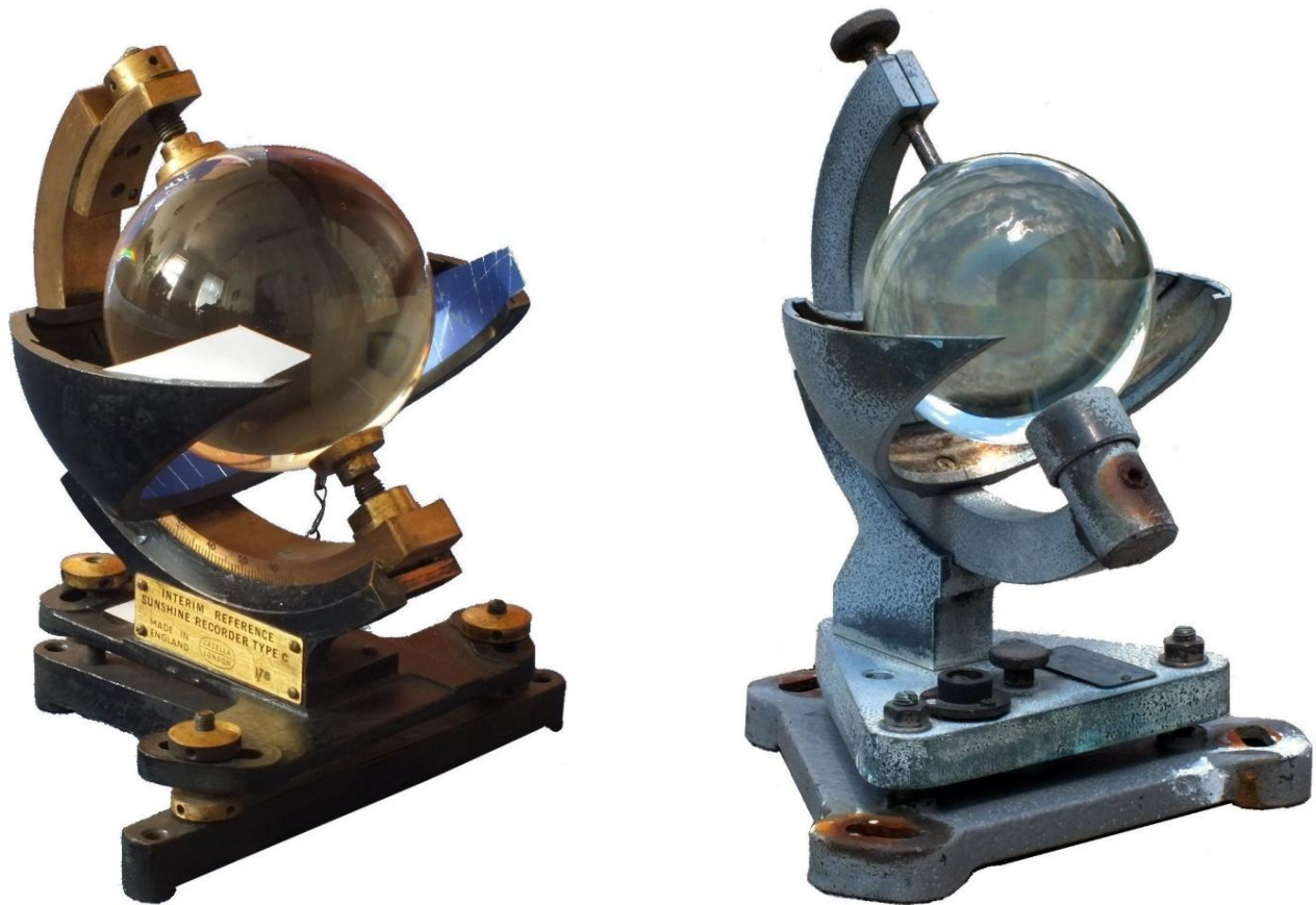
Az Országos Meteorológiai Szolgálat Meteorológiai Muzeális Szakgyűjteményében őrzött Casella és Fuess gyártmányú Campbell–Stokes típusú napfénytartam-mérők
