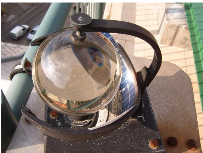
3. ábra: Campbell–Stokes rendszerű napfénytartam mérő (OMSZ, 2014)
