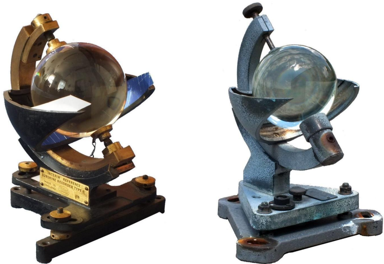
Az Országos Meteorológiai Szolgálat Meteorológiai Muzeális Szakgyűjteményében őrzött Casella és Fuess gyártmányú Campbell–Stokes típusú napfénytartam-mérők
