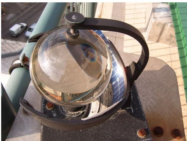
3. ábra: Campbell–Stokes rendszerű napfénytartam mérő (OMSZ, 2014)
