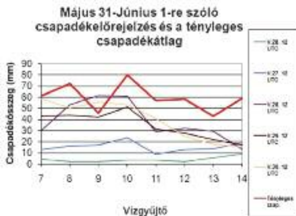
23/a ábra. Az egyes előrejelzések és a ténylegesen mért adat összehasonlítása a 2010. május 31.–június 1. csapadék esetén Vízgyűjtők: 7 – Vág, Garam, Ipoly; 8 – Közép-Dunavölgy; 9 – Zala, Balaton; 10 – Kapos, Sió; 11 – Sajó, Hernád; 12 – Zagyva; 13 – Közép-Tiszavölgy; 14 – Bodrog
