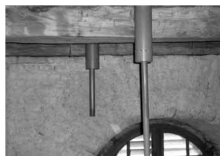
A harang megszólaltatásának manapság leggyakoribb eszköze a húzómágnes
