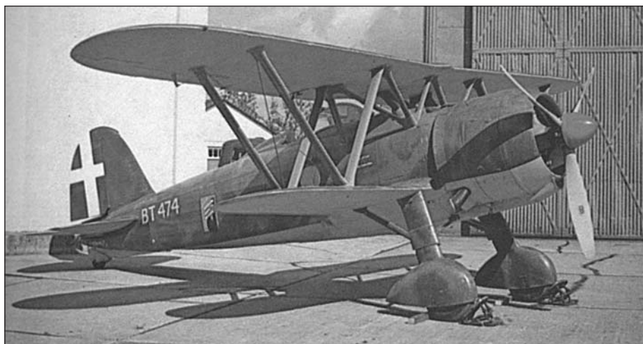
A tizennyolc éves fejlesztés után épített C.R-42-es. A merev futóművet áramvonalasták, a motor vízhűtéses, a fő szerkezeti elemek azonban változatlanok
