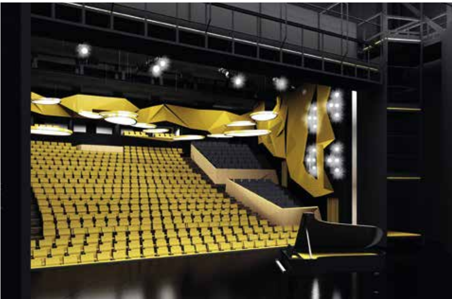
A meglévő nézőtér geometriája változatlan, a kétoldali, magas mellvédés zártzések kijavítják az akusztikai hibákat. Az oldalfalakon méretezett szitaszövet burkolati rendszerrel hangolható fel a nézőtér a prózai, opera-, balett- és musical-előadásokra
