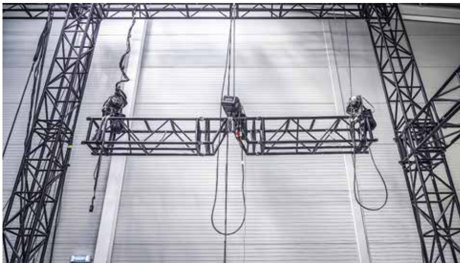
A több irányba mozgatható emelőberendezés rácsos tartószerkezete
