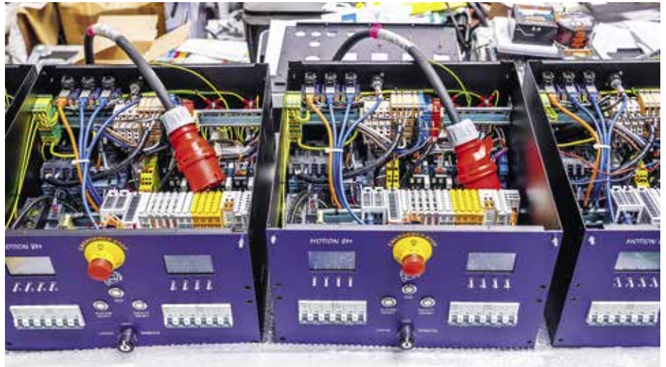
Az akár 24 tengely vezérlésére alkalmas, Beckhoff CK9020 beágyazott számítógépet, EL-terminálokat és biztonsági modulokat alkalmazó berendezés vezérlődoboz
