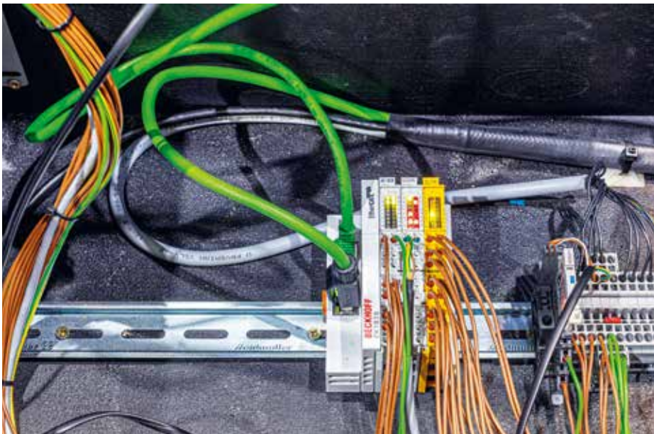
Az előszínpadi rendszer kezelőpultjában elhelyezett integrált digitális kimeneteket tartalmazó EK1828 EtherCAT-csatoló, potenciométer közvetlen csatlakoztatására alkalmas EL3255 EtherCAT-terminál, valamint a különböző helyiségekben található számos biztonsági kapesoló, beesípődésérzékelő és vészstopgomb csoportos kezelésére alkalmas EL1918 biztonsági terminál
