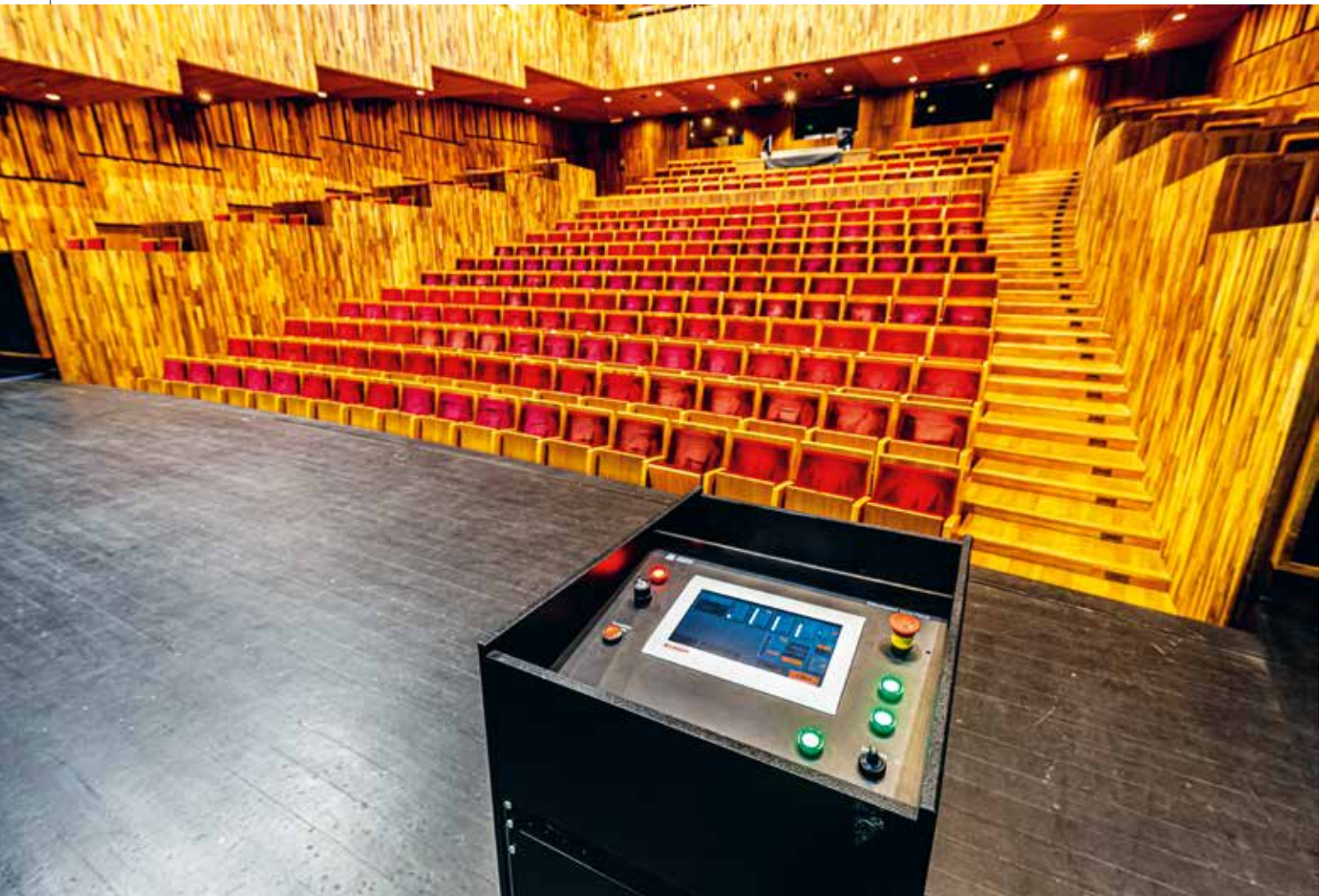
Az akár 10 tengely vezérlésére is alkalmas, ARM-Cortex™ processzorral rendelkező CP6600 típusú beépíthető panel PC-vel ellátott előszínpadi rendszer kezelőpultja
