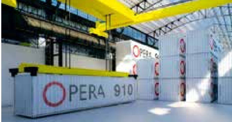
A konténeres raktározás látványterve (KÖZTI), de végül a futódaru helyett négyutas targoncák mozgatják majd a konténekeket
