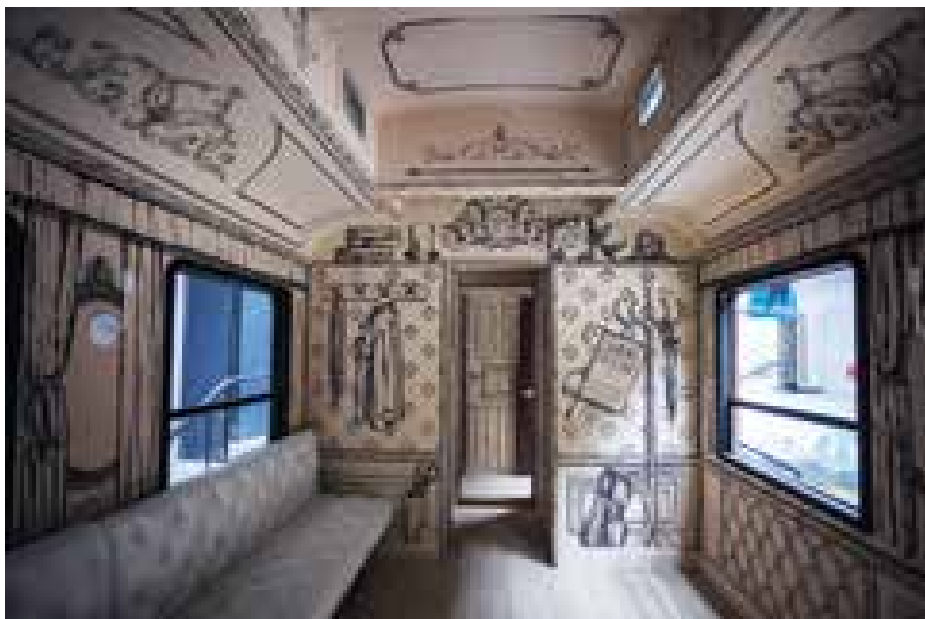
A Wagon-Lits WR 2354 típusú, tikfa burkolatú favázas étkezőkocsiját 1912-ben a csehországi nesseldorfi vagongyár készítette, két külön étkezőszekkasszal, 18+24 ülőhellyel. A műszaki emléket esztétikailag felújították.
