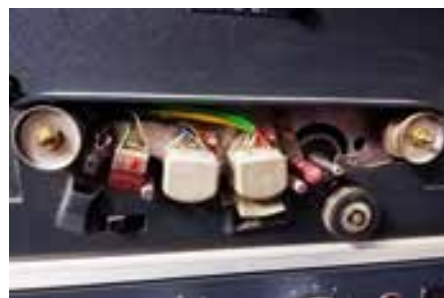
Optikai érzékelő és a három fej szépen sorban: törlő, felvevő és lejátszó
