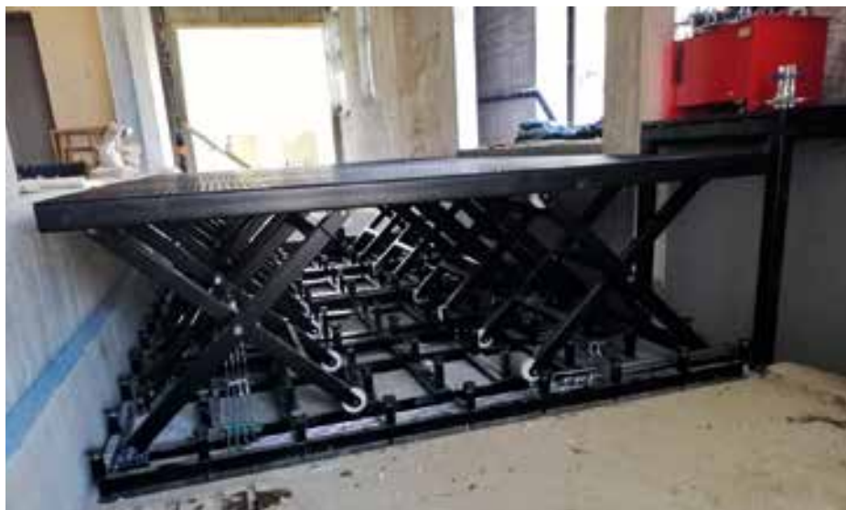
A gépkocsiráhajtóba épített ollós emelő
