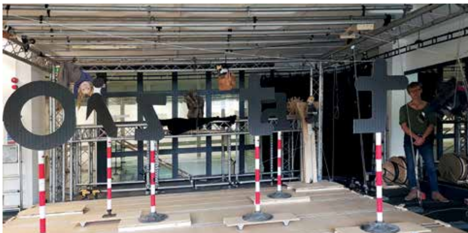
► A kulisszás díszletek mozgatóját bemutató szerkezet
