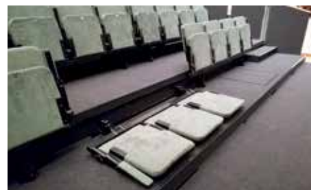
► A lehajtott ülések, a tribünt két ember fél óra alatt csukja össze
