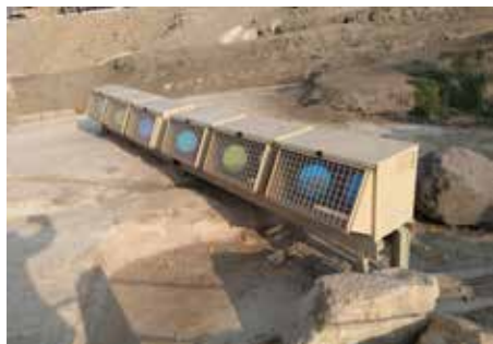
► Fényvetők csoportosítása (egy dobozban két eszköz, egy csoportban 3-12 doboz)
