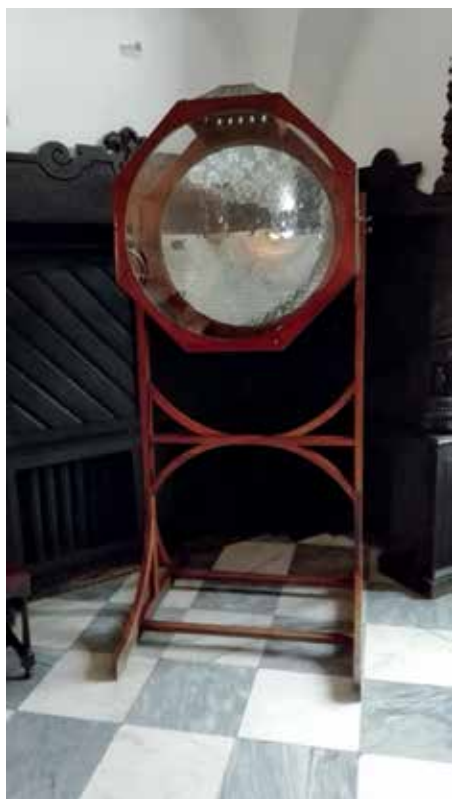
► Az utód: ez a fényszóró a nieboróvi kastélyban valószínűleg Iwan Kulibin (1735–1818) alkotása és Andreas Gärtner darabjának a továbbfejlesztése. A parabolatükrös fénylvető ma is kipróbálható
