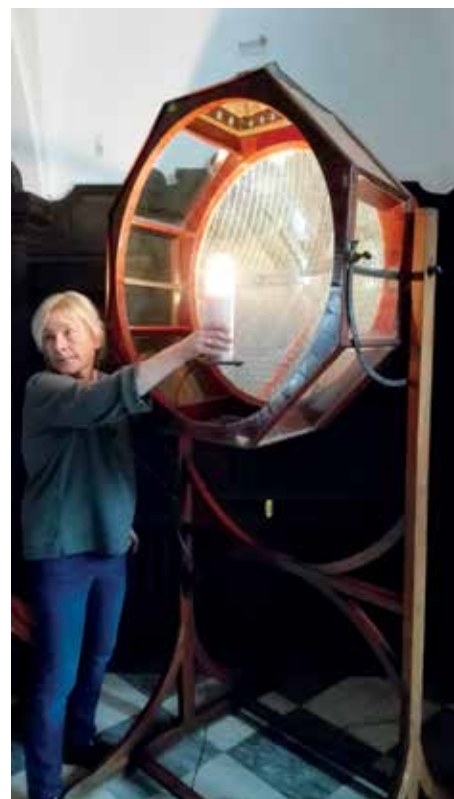
► Az utód: ez a fényszóró a nieboróvi kastélyban valószínűleg Iwan Kulibin (1735–1818) alkotása és Andreas Gärtner darabjának a továbbfejlesztése. A parabolatükrös fénylvető ma is kipróbálható
