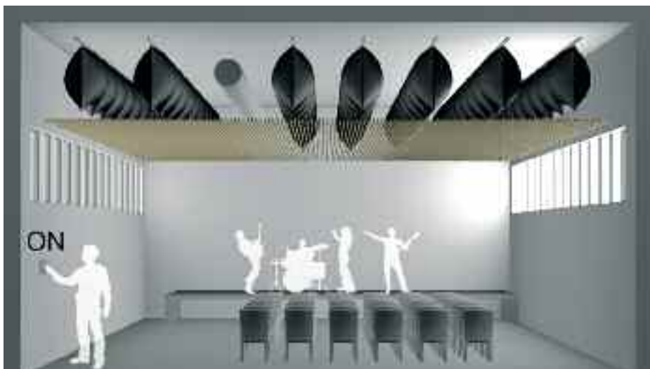
2. ábrák. Egy tartósín, akusztikailag transzparens mennyezeti borítás fölé beépített AqFlex®-rendszer ábrája inaktív és aktív üzemmódban.
