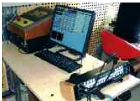
Balra a forgószínpad-, középen a lézervezérlő, jobbra az ügyelőpult
