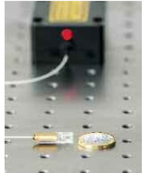
Előtérben a miniaturizált MicrOS mikrofon. 4x4x11 mm.
