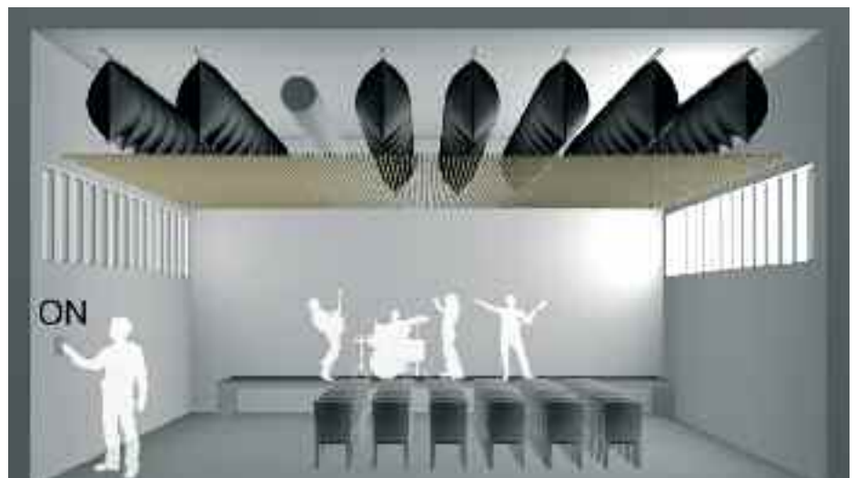
2. ábrák. Egy tartósín, akusztikailag transzparens mennyezeti borítás fölé beépített AqFlex®-rendszer ábrája inaktív és aktív üzemmódban.
