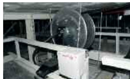
Rugós kötéldob az áramellátáshoz
