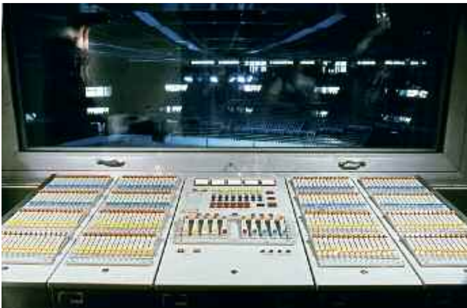
10. ábra. 120 áramkörös két előbeállító, elektronikus vezérlőasztal (Budapest Sportszarnok 1982)
