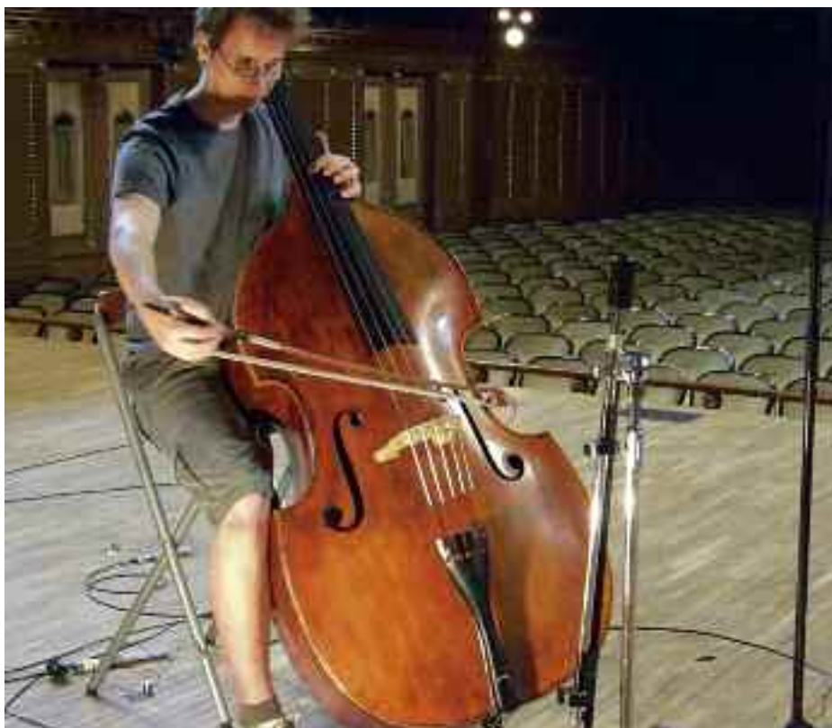
9a és b ábra: A pódium padlószervezetének vizsgálata (a) impulzuskalapáccsal történő mesterséges, ill. (b) nagybőgővel biztosított természetes gerjesztéssel.
