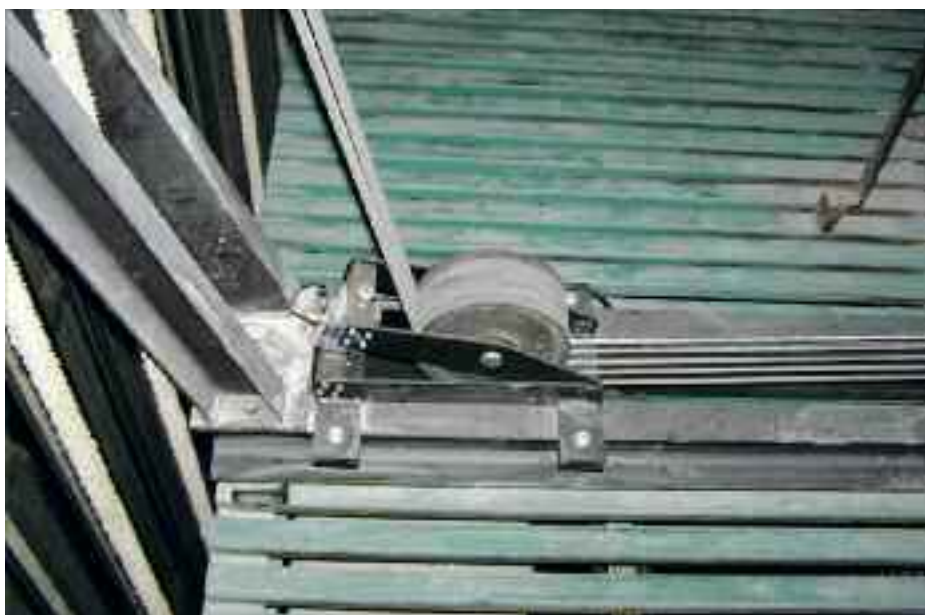
Zsinórpádlás a terhelésmérő kötélteléréssel
